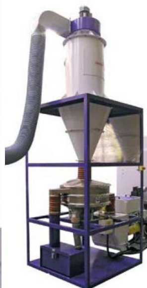
Система рециркуляции пескодувного материала для установок типа Multiblast
