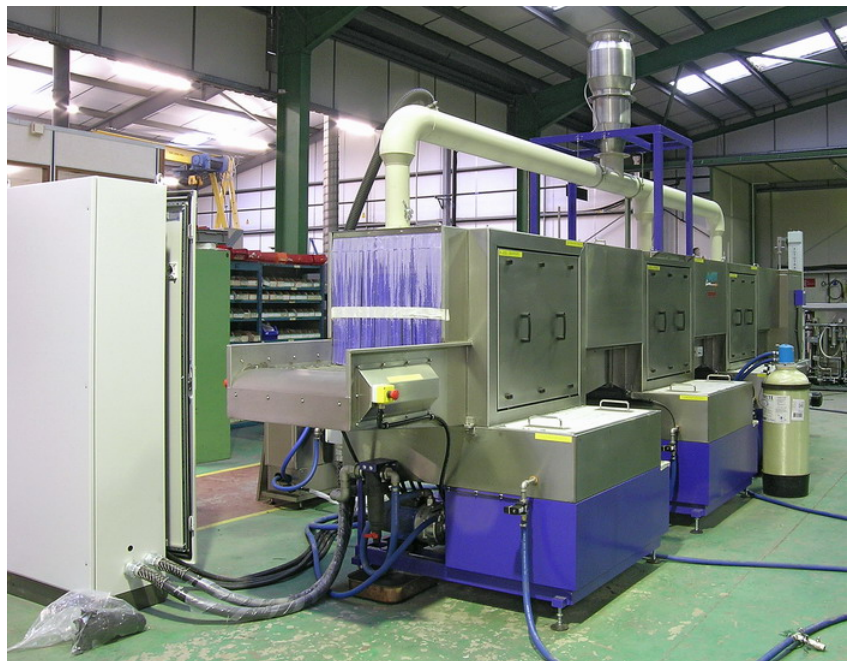
Система Marr-Line в цехе завода Guyson в Skipton проходит отладку на соответствие требованиям технического задания на очистку деталей
