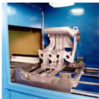
Конвейерная обработка громоздкой детали - впускного коллектора ДВС
