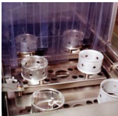
Мойка втулок подшипников на конвейере
