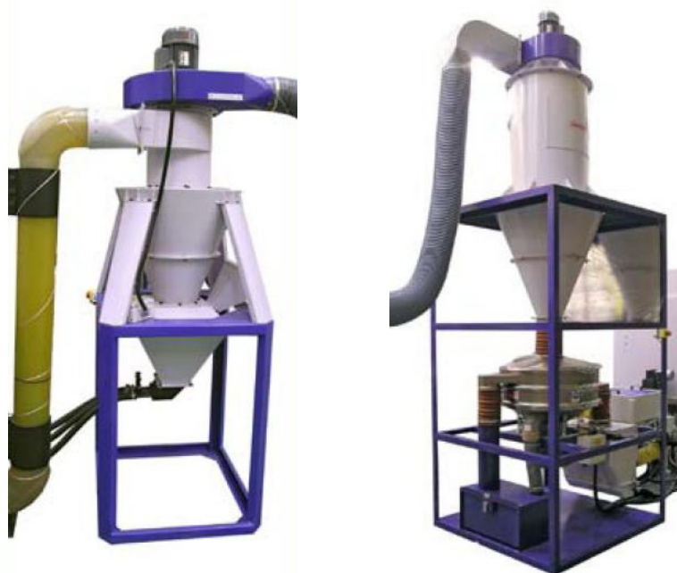
Циклоны для сепарации пескодурных материалов
