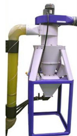
Циклон для сепарации пескодувных материалов
