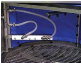
Расположение форсунок в рабочей зоне
