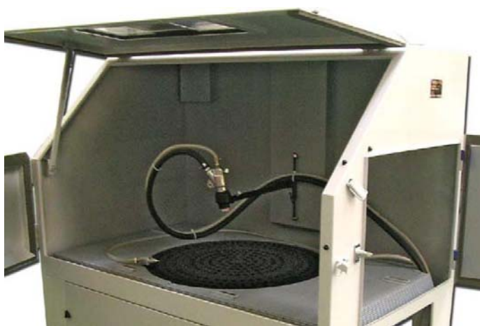
Конструкция камер позволяет легкий доступ к поворотному столу во всех направлениях
