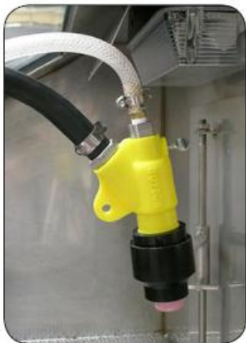
Пескоструйный пистолет с пластиковым корпусом
