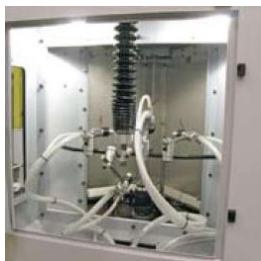
Рабочая зона камеры с системой форсунок
