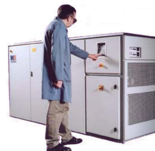
Система ультразвуковой очистки Microsolve 3-sump с монорастворителем
