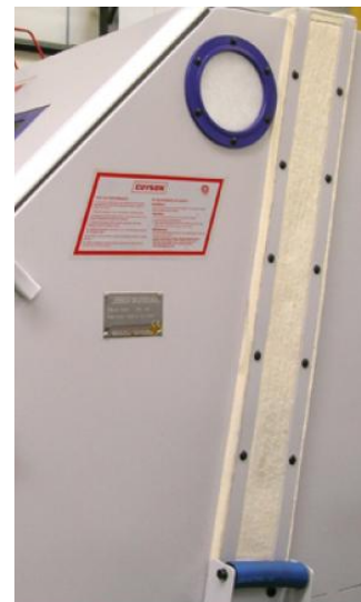
Войлочный буфер для загрузки плоского стекла в камеру
