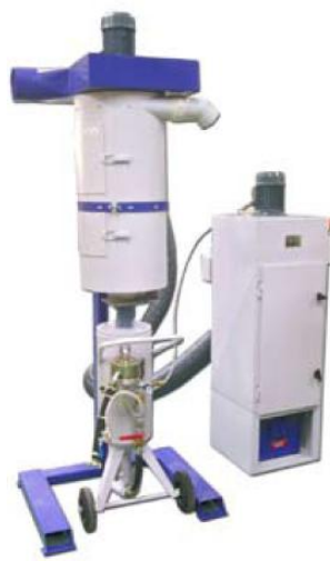
Циклон-рециркулятор G27 с пылевой камерой C400
