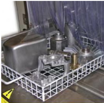
Подача деталей по конвейеру в корзине
