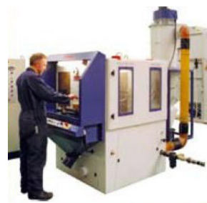
Система Multiblast с индексированным шпинделем
