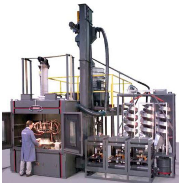
Система рециркуляции пескодувного материала для установок типа Multiblast
