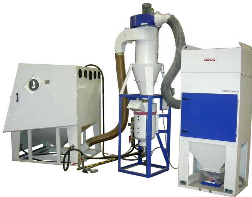
Комплекс оборудования Euroblast 10 с циклоном-рециркулятором G55 и пылевой камерой C800 для пескоструйной обработки больших деталей
