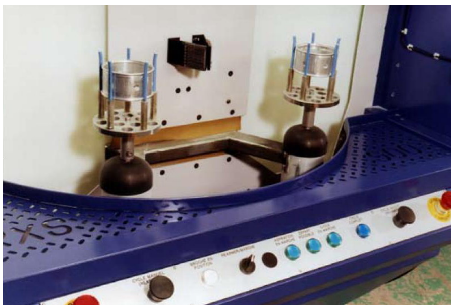
Крепление деталей в барабане системы Multiblast
