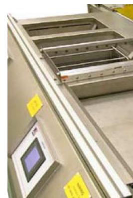
Отсеки мойки, промывки и сушки
