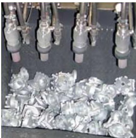
Пескоструйные пистолеты в камере Tumbleblast
