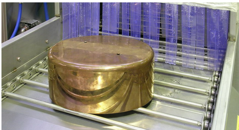
Воздушные шаберы, воздух для продувки, нагревание, вакуумная сушка
