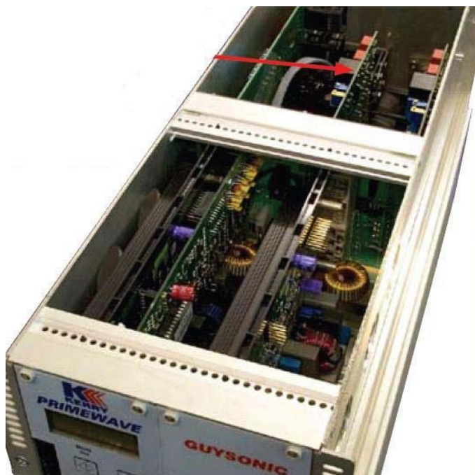
Модульная конструкция генератора
