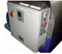
7-дневный таймер и автомат регулирования температуры
