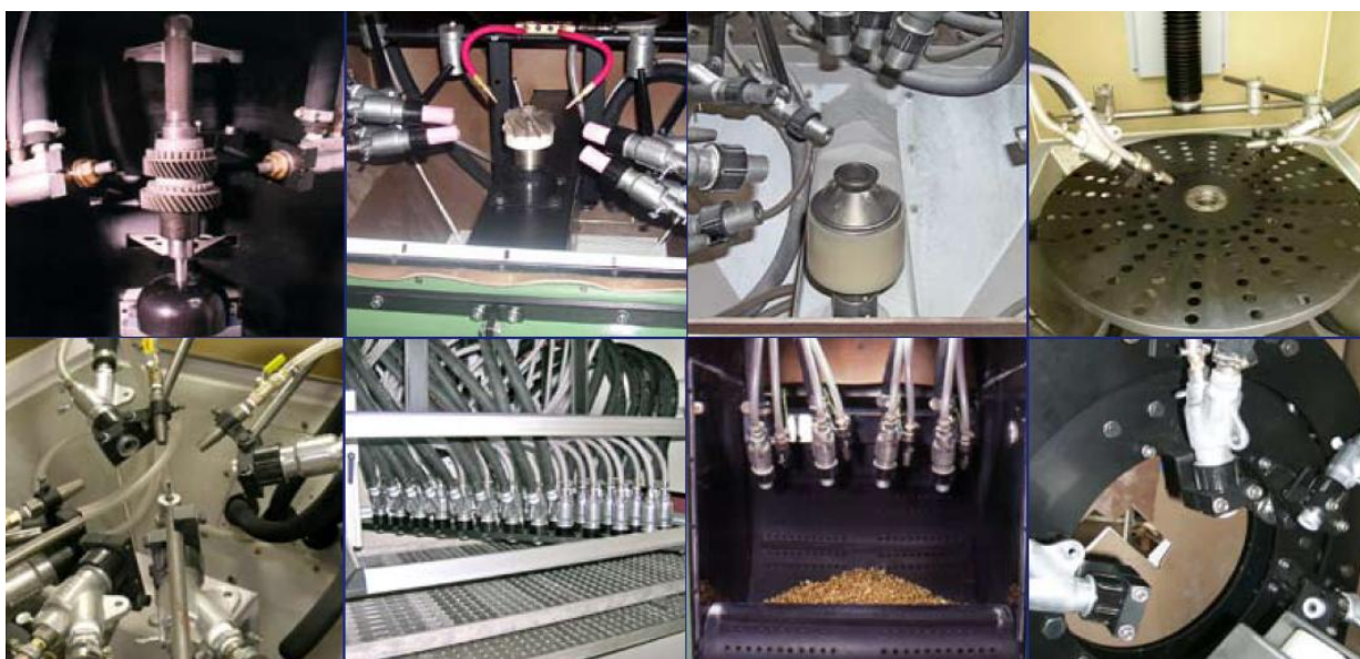
Варианты и элементы конструкции гибких автоматизированных систем пескоструйной обработки
