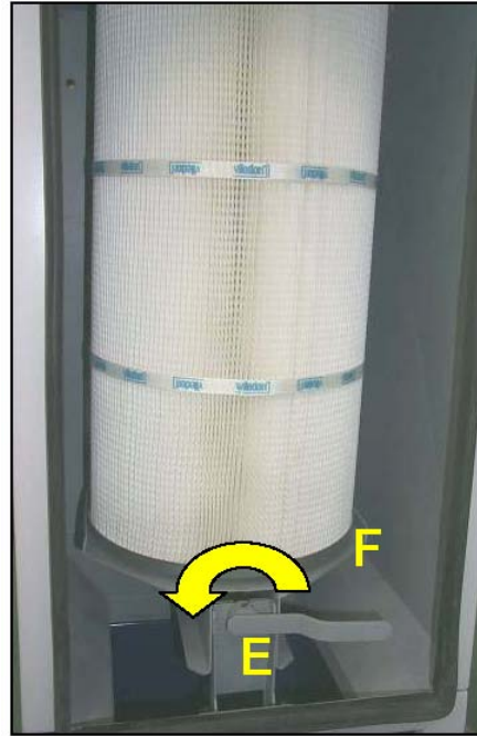
Рисунок 15: Удаление патрона фильтра (С400 МК4)
