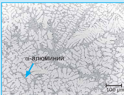
б) доэвтектический с зернистой структурой
