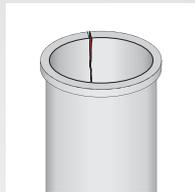
Продольные трещины гильзы цилиндра 65
