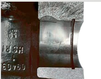
Рис. 3 Поперечное сечение бобышки поршня
