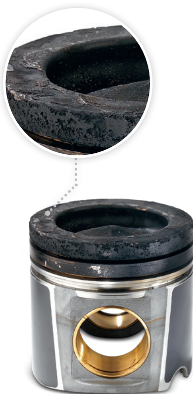
Рис. 3. Слой масляного нагара на жаровом поясе
