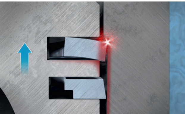
Рис. 3. Удары поршневого кольца нового поршня
