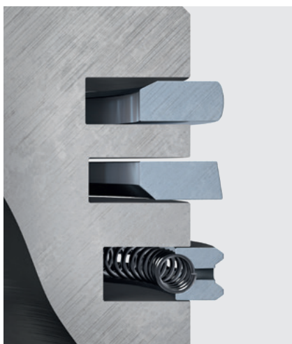
Рис. 2. Поршневые кольца в ненапряженном состоянии: скручивание пока отсутствует
