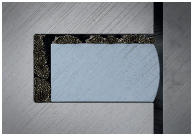
Рис. 1. Загрязнения в кольцевой канавке
