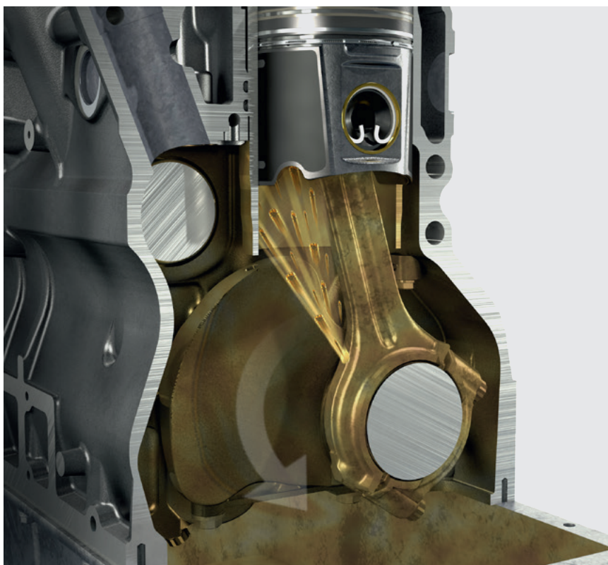
Рис. 1. Имеющиеся в шатуне отверстия для разбрызгивания масла обеспечивают надежное смазывание рабочей поверхности цилиндра
