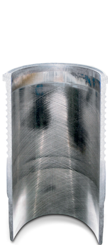
Рис. 2. Блестящие, отполированные места в верхней части цилиндра
