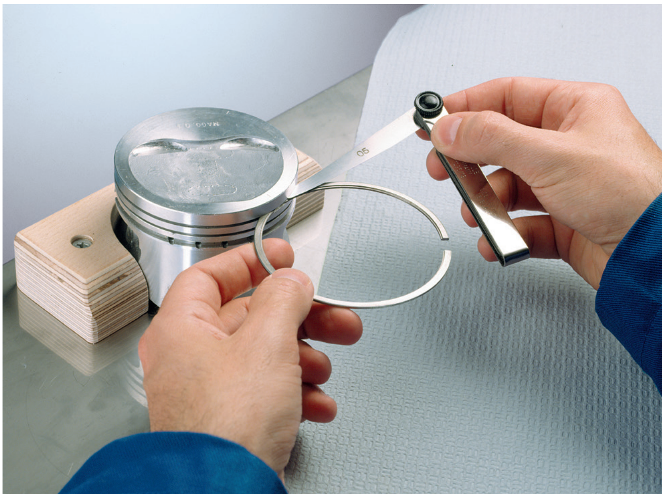
Рис. 1. Измерение зазора кольца по высоте
