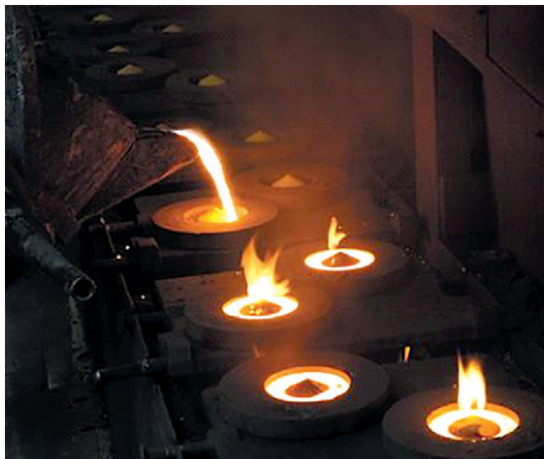
Процесс литья поршневых колец
