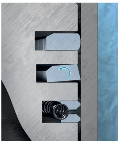
Рис. 3. Положительное скручивание кольца
