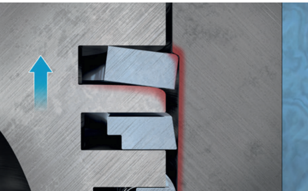
Рис. 2. Удары поршневого кольца бывшего в эксплуатации поршня
