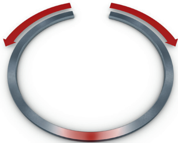
Рис. 1. Чрезмерное растягивание поршневого кольца
