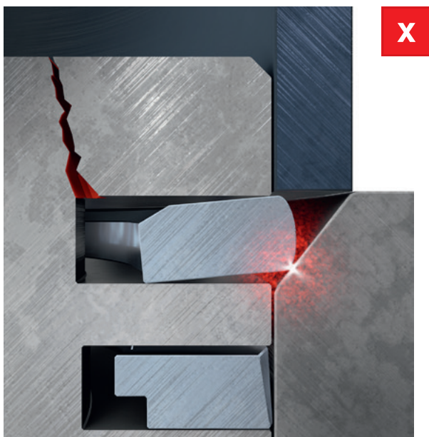
Рис. 1. Слишком большая фаска по краю цилиндра: при монтаже поршневое кольцо зажимается между лентой монтажной оправки и цилиндром, блокируя поршень.
