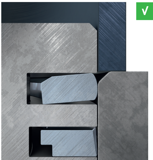
Рис. 2. Фаска небольшого размера по краю цилиндра: поршневое кольцо скользит вдоль зазора.
