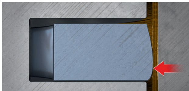
Рис. 3. Рабочая поверхность кольца асимметричной выпуклой формы
