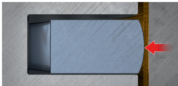
Рис. 2. Рабочая поверхность кольца симметричной выпуклой формы
