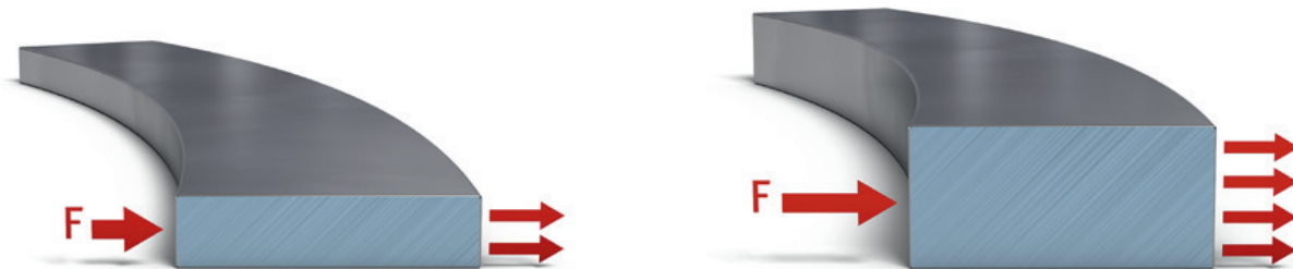
Рис. 2 и Рис. 3. Упругость кольца и специфическое усилие прижима
