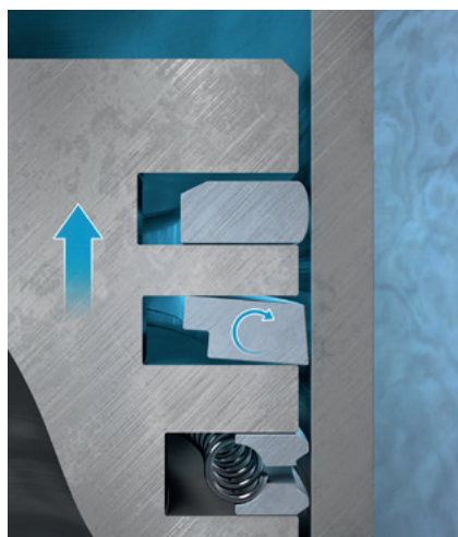
Рис. 5. Отсутствие давления сгорания
