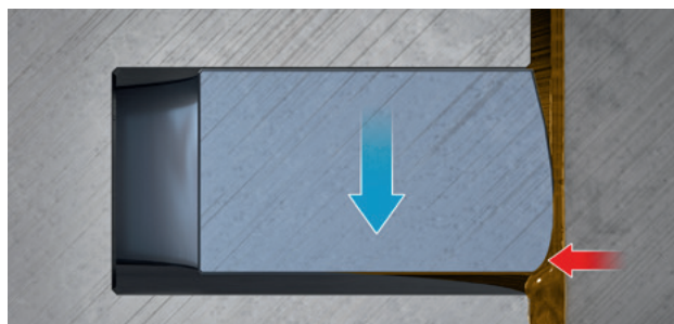
Рис. 5. Слабое «всплывание» при движении вниз
