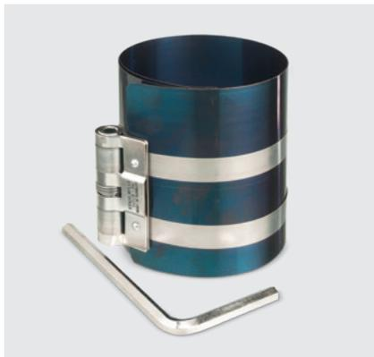
Плавно регулируемые ленточные оправки обеспечивают быструю и надежную установку поршней в отверстия цилиндров. Они изготовлены из специальной пружинной ленточной стали и имеют черненую, частично никелированную поверхность.
