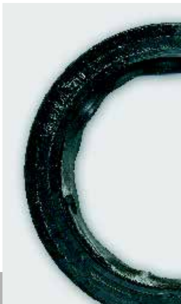
▲ Повреждённая уплотнительная манжета из ПТФЭ как причина неисправности.
