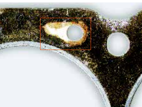
▲ Разбухание композитной прокладки головки блока цилиндров из-за перегрева с образованием пара.
