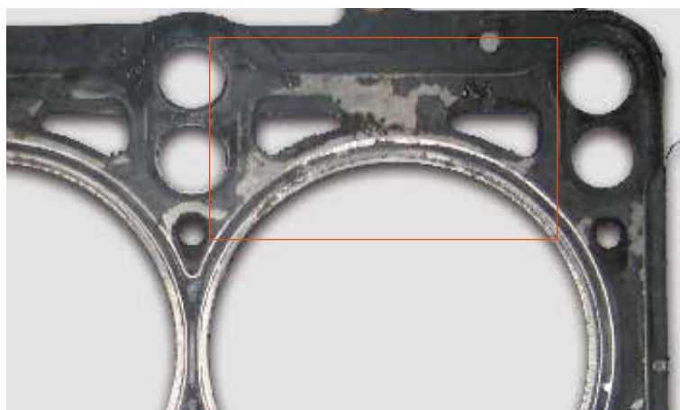
▲ Эластомерное покрытие, поврежденное в результате перегрева
