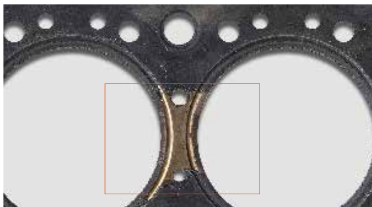
▲ Сгоревшее эластомерное покрытие
