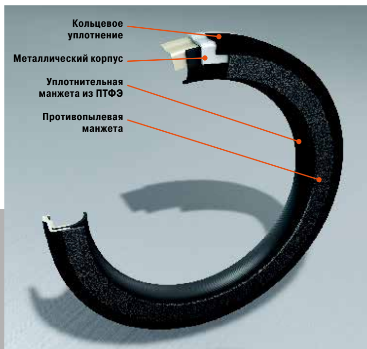
Конструкция сальника с уплотнительной манжетой из ПТФЭ.
