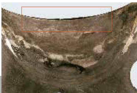
▲ Повреждение уплотнения в результате нарушения фиксации вихревой камеры Рикардо. Распорный элемент разломан в двух местах и выдавлен наружу.
