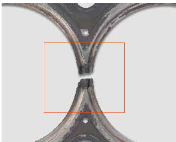
▲ Разлом перемычки из-за высокой динамики детали
