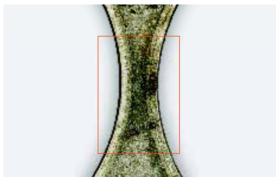
▲ Газовая протечка с местным почернением ложа поршневого кольца.
