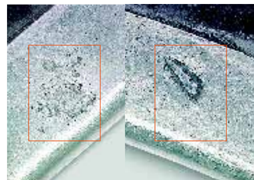
▲ Повреждение прокладки вследствие запрессовки грязи и инородных предметов
