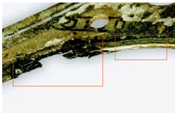
▲ Вдавливание и смятие вследствие преждевременного зажигания - с прорывом газов или без него.
