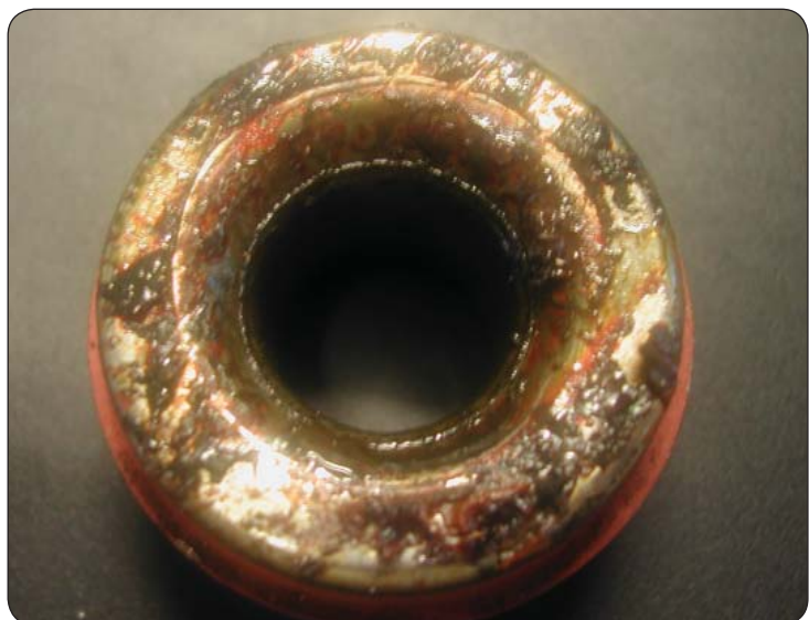
Сильное повреждение динамического уплотнения.
