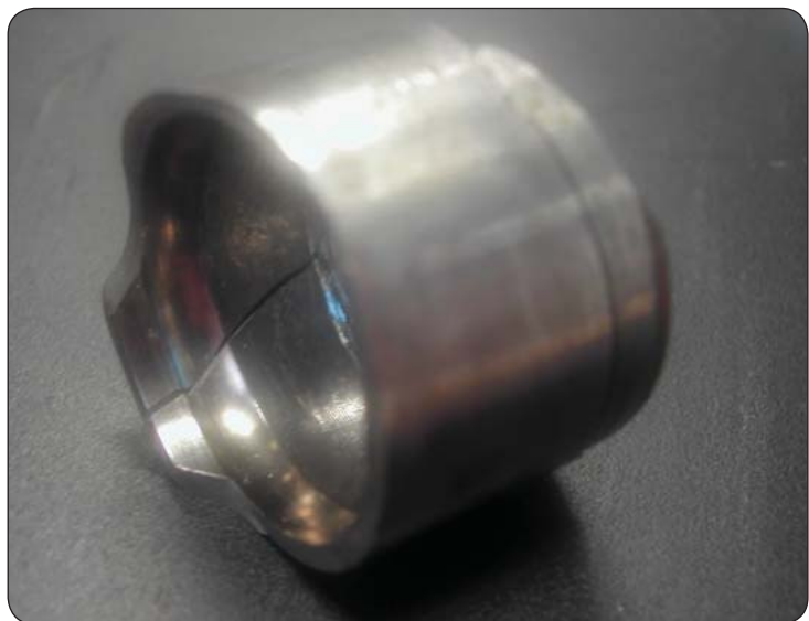
Сильное повреждение динамического уплотнения.
