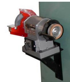
**Заточное приспособление для резцов.**
