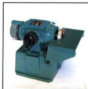
Заточное устройство для резцов
