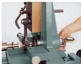
**4. Центрирование шатуна для шлифовки.**
