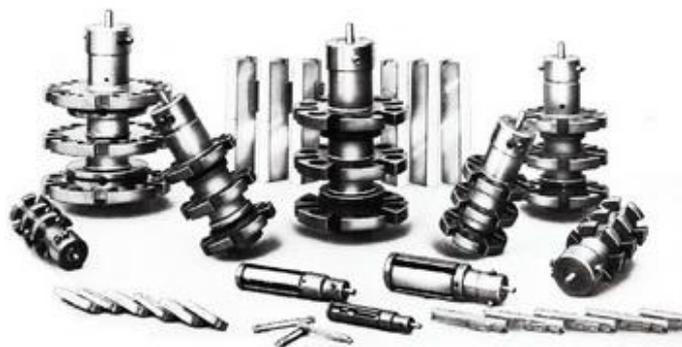
Новый ряд хонеров был специально сконструирован для того, чтобы добиться лучших результатов в удалении припуска и демпфирования вибраций. Хонинговальные инструменты с плавным гидравлическим расширением – давление расширения равномерно и плавно приводит в действие все бруски, чем обеспечивается совершенное и однородное действие абразива на поверхность отверстия для достижения наилучших результатов хонингования.
