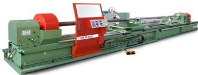
Позволяют хонинговать трубы длиной до 8000 мм и внутренним диаметром 26-400 мм. Трубные горизонтально-хонинговальные станки линии LYOR являются одними из лучших машин в данном классе станков. Имеют плавную регулировку вращения и подачи шпинделя, вращения детали, а также гидравлическую подачу брусков хонинговальной головки на разжим.
