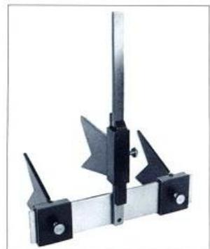
Устройство для измерения радиуса кривошипа
