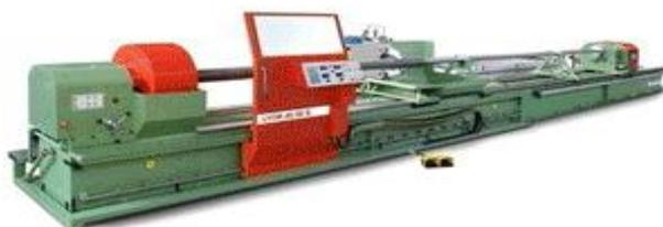
Горизонтальные и вертикальные хонинговальные станки Robbi выделяются своей жесткостью и мощностью. В результате более чем 60-летнего опыта в строительстве хонинговальных машин была разработана двойная ротационная система рабочей бабки, которая гарантирует оптимальную цилиндричность отверстий даже в очень длинных заготовках.
