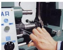
**5. Грубая регулировка припуска на шлифование.**
