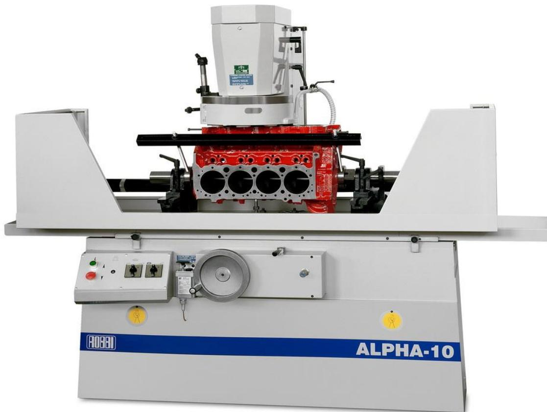
Широкая линия высокоточных станков для шлифования и фрезерования плоских поверхностей блоков, головок блока цилиндров и других деталей с максимальной длиной обработки от 950 до 2600 мм. Рекомендуется для ремонта двигателей ведущими производителями тяжелой техники Caterpillar и Comatsu, а также известным производителем комплектующих для тяжелых машин – фирмой Maruma (Япония). Окраска станков в любой цвет по выбору заказчика.
