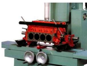
Регулируемое наклонное крепление для зажима V-образных блоков цилиндров.
