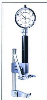
Специальные нутромеры 35-100 мм и 100-220 мм для измерения диаметра постели без демонтажа борштанги
