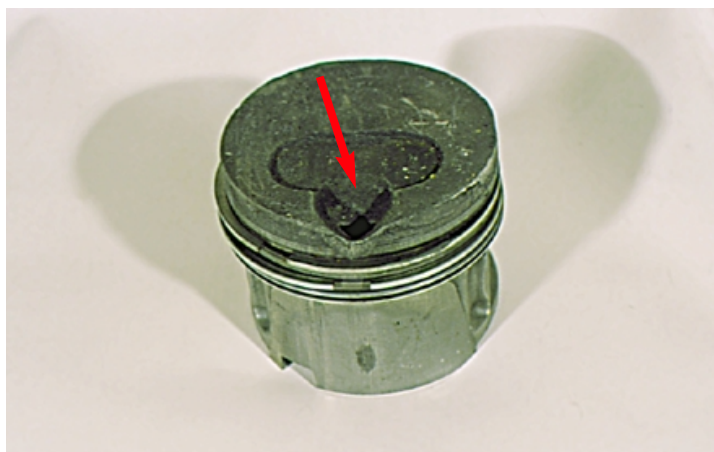
Дефект распылителя привел к прогару поршня.
