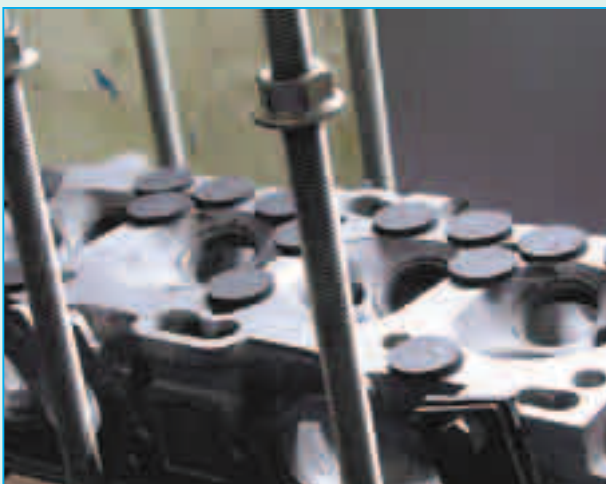
Каналы системы охлаждения, открывающиеся в привалочную плоскость головки, закрываются уплотняющими прокладками.
