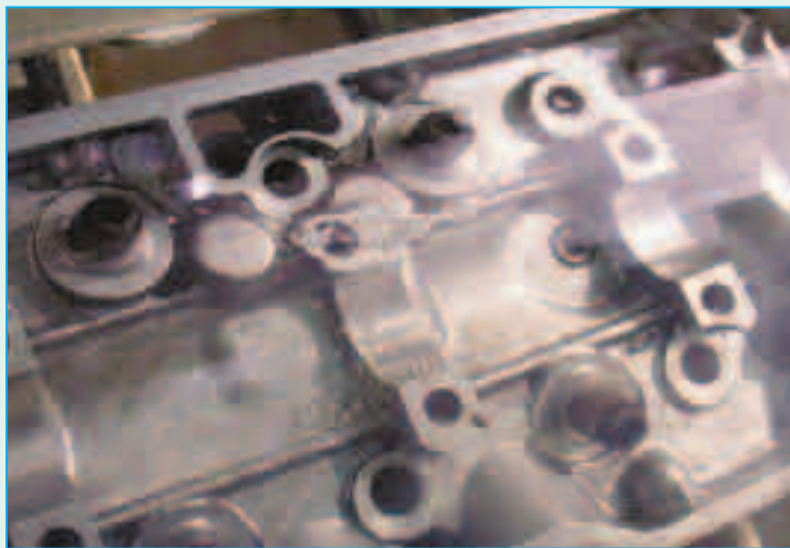
Пузырьки воздуха наглядно показывают местоположение трещины. В данном случае она находится вблизи одной из опор распределительного вала.
