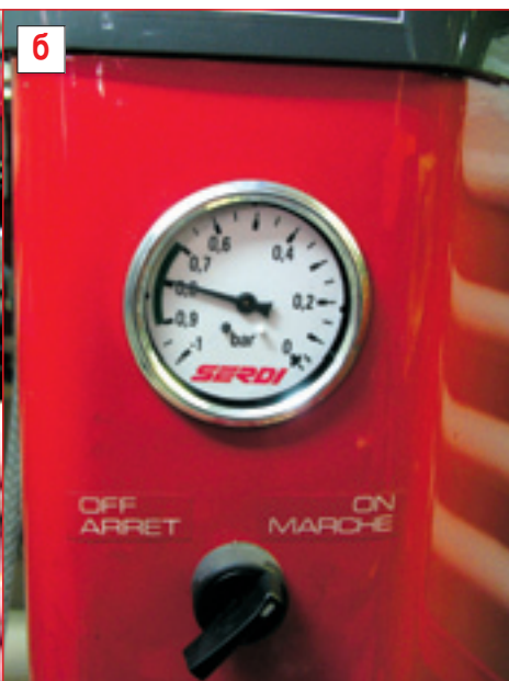
Для контроля плотности посадки клапана в седле служит вакуумтестер — необходимо установить клапан на место, поднести к отверстию канала насадку (а) и прочитать показания прибора (б).
