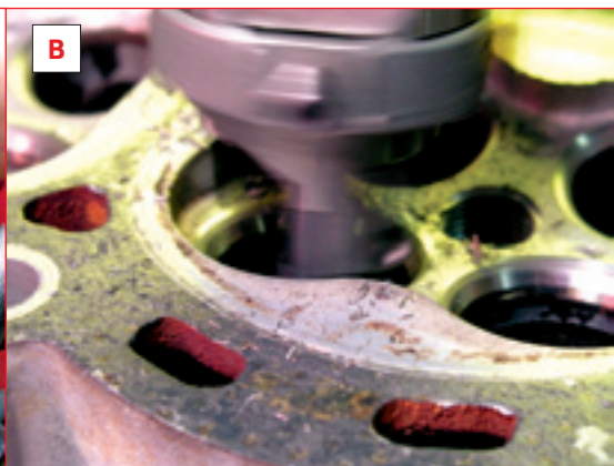
Достаточно попасть пилотом в отверстие направляющей втулки, включить на несколько секунд сферическую и малую плоскую воздушные подушки (а), затем установить скорость вращения шпинделя (б), чтобы начать обработку седла (в).
