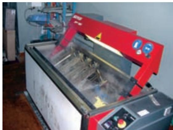
**Установка по проверке герметичности рубашки охлаждения — при ее отсутствии в цехе есть смысл серьезно задуматься: а надо ли вообще тратить собственные силы и клиентские деньги на ремонт головок блока цилиндров «вслепую»?**
