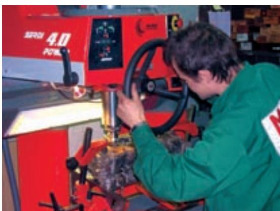
Специализированное оборудование для обработки седел, без которого ремонт современных головок блоков цилиндров невозможен в принципе. Пытаться сравнивать такой станок по качеству обработки и производительности с «подручными» инструментами для седел просто не имеет смысла.
