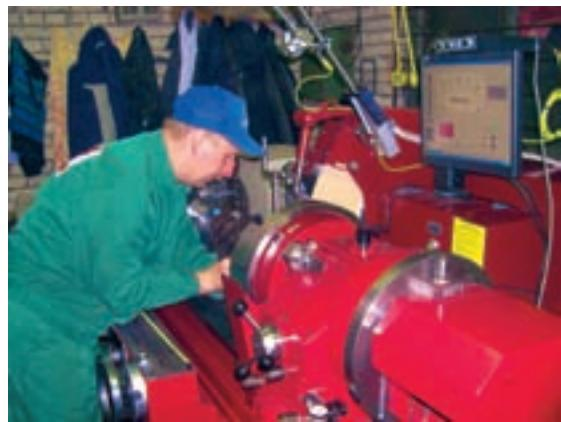
**Нормальный шлифовальный станок для коленчатых валов — не прихоть. По точности его просто нельзя сравнить с устаревшим отечественным оборудованием. А по производительности он легко заменит сразу два старых станка, причем только экономия от его эксплуатации в течение нескольких лет после такой замены может превысить 30–40 тыс. евро.**
