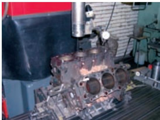
Для того чтобы правильно поставить блок цилиндров на отечественный универсальный расточечный станок, помимо самодельной оснастки придется воспользоваться и самодельным измерительным инструментом, чего не потребуется для специализированного расточечного станка, где удобство работы приведет не только к существенной экономии времени, но и более высокому качеству обработки.
