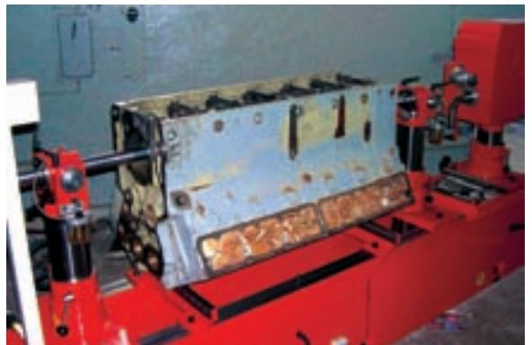
**Специализированный горизонтально-расточной станок практически не имеет «универсальной» альтернативы — без него любой дефект постелей подшипников приведет к неизбежной выбраковке блока или головки блока цилиндров.**
