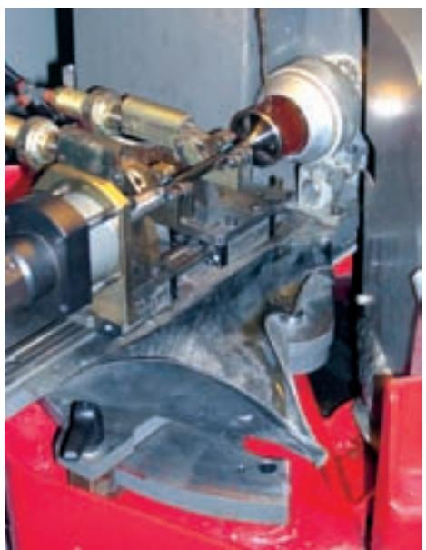
Специализированный станок для шлифовки фаски клапанов даст «фору» любому универсальному «подручному» станку по всем параметрам.
