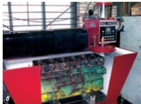
*«Подручный» универсальный отечественный станок, оснащенный самодельным инструментом, конечно, обработает плоскость (а), однако по всем параметрам — точности, качеству поверхности, производительности — существенно проигрывает специализированному станку иностранного производства (б).*
