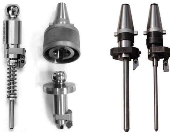
Рис.3. Элементы режуще-центрирующей части станков различных схем: слева – держатели с шарниром, профильным резцом и пилотом, в центре – модернизированный байонетный шарнир с ограничителем (шарнирная схема), справа – держатели с резцом и пилотом (жесткая схема)
