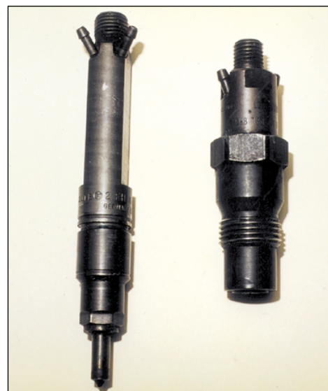
Форсунки дизелей VW последнего поколения (слева) существенно отличаются от форсунок, устанавливавшихся на двигателях прошлых лет (справа).
