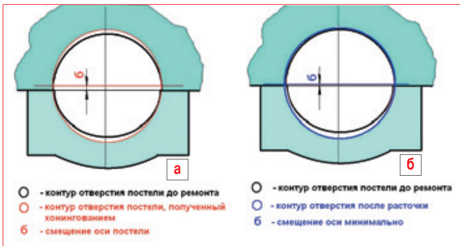
Схема обработки постели с «заниженной» крышкой — при хонинговании (а) ось постели сама займет некое среднее положение, а при расточке (б) положение оси может быть задано с учетом минимального припуска на блоке. В последнем случае смещение оси коленвала вверх будет контролируемым и минимальным, равным этому припуску. В первом случае все наоборот — контролировать смещение оси невозможно, и оно будет приблизительно равно половине общего припуска на обработку.
