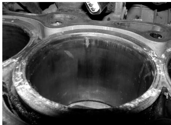
Рис.6. Задиры в верхней части цилиндра от перегрева при потере ОЖ (хорошо видны следы прорыва газов на плоскости). Нижняя часть цилиндра поврежденной не получила.
