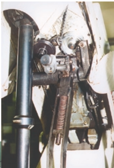
Отечественный станок ЗГ833 имеет реечный привод шпинделя и две фрикционные электромагнитные муфты изменения направления подачи.
