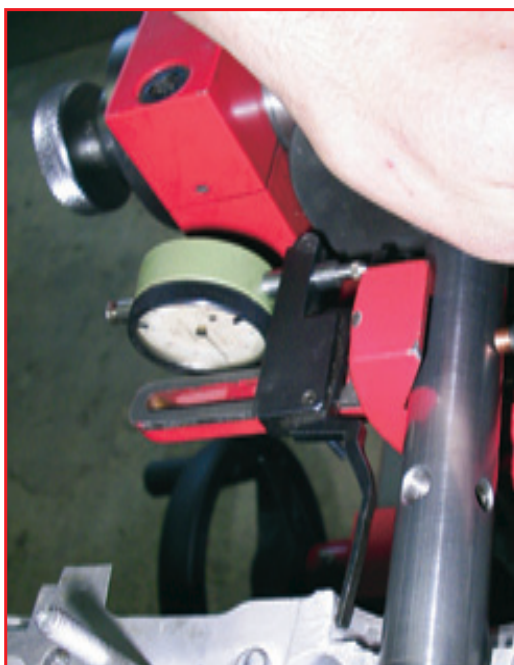
При окончательной выверке головки блока на станке используется специальный микрометрический прибор, позволяющий обкатывать ножкой индикатора базовую поверхность.
