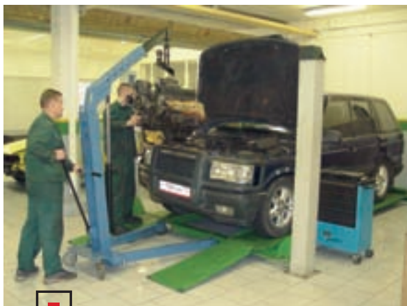
Монтаж двигателя не представляет больших трудностей, особенно если выполняется бригадой, которая его снимала.
