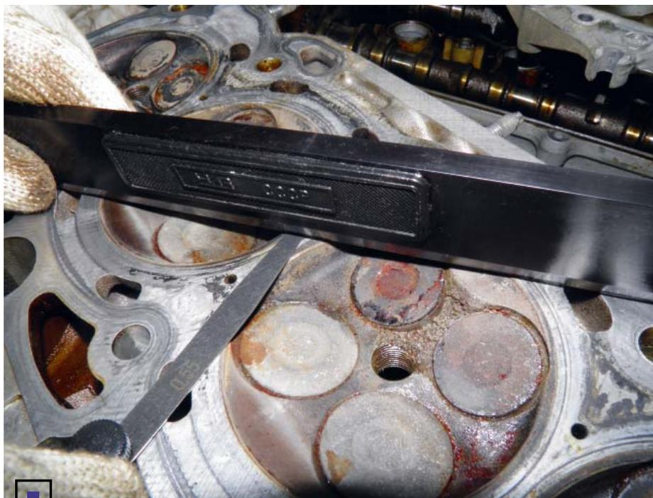
□ Типичный признак перегрева двигателя в его начальной стадии — деформация плоскости головки блока
