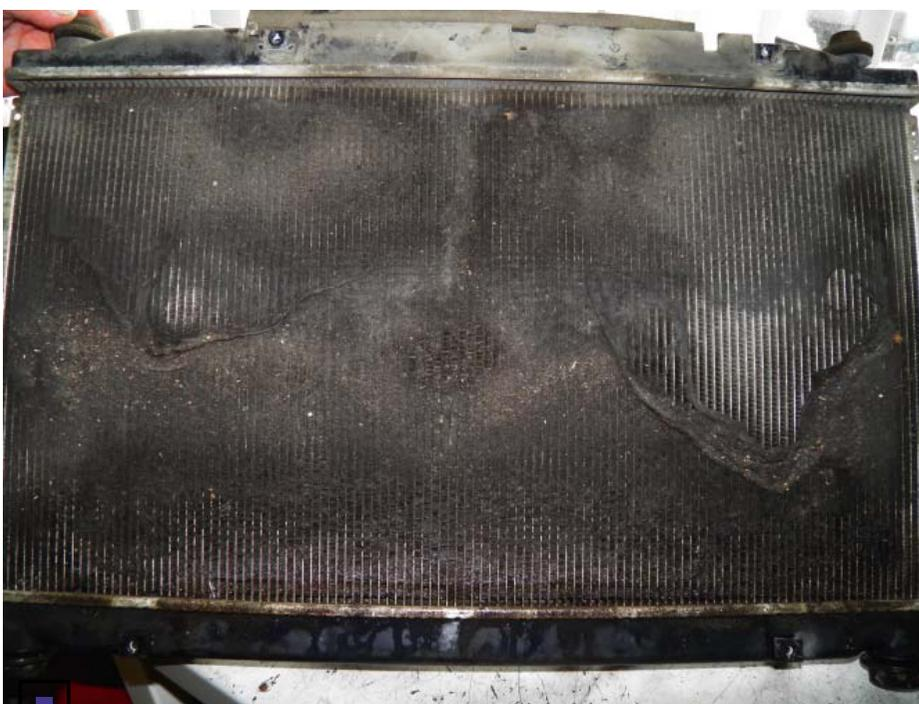
Когда значительная часть жидкости вытекла, забитый пухом радиатор уже не влияет на процесс — даже если его полностью очистить, циркуляция по большому кругу не появится, и охлаждение двигателя не восстановится.
