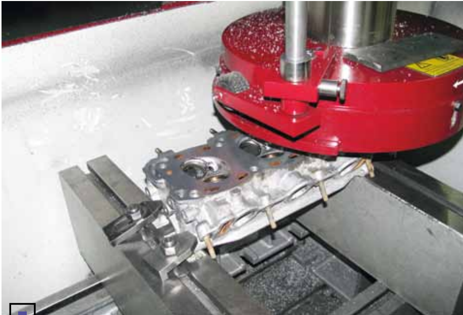
Одна из самых востребованных сегодня ремонтных операций – обработка плоскости головки блока
