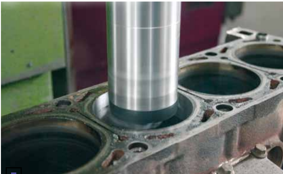
□ Без расточки изношенный блок цилиндров не починить. Однако и эта операция имеет тенденции к снижению популярности
