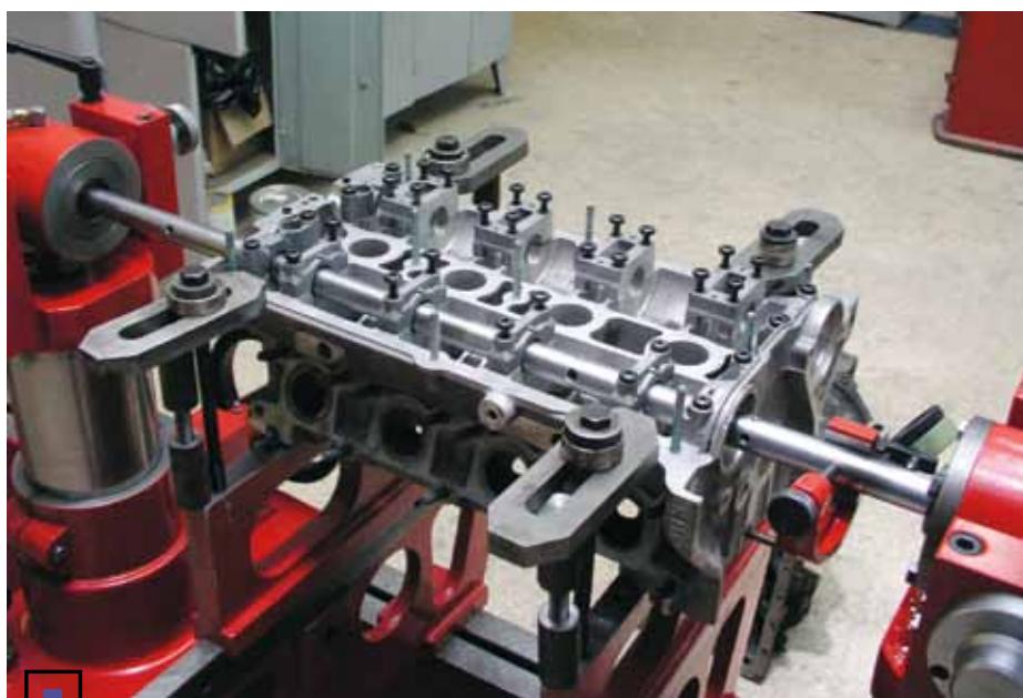
□ Расточить постель подшипников в головке блока тоже можно, но сегодня дешевле головки просто заменить
