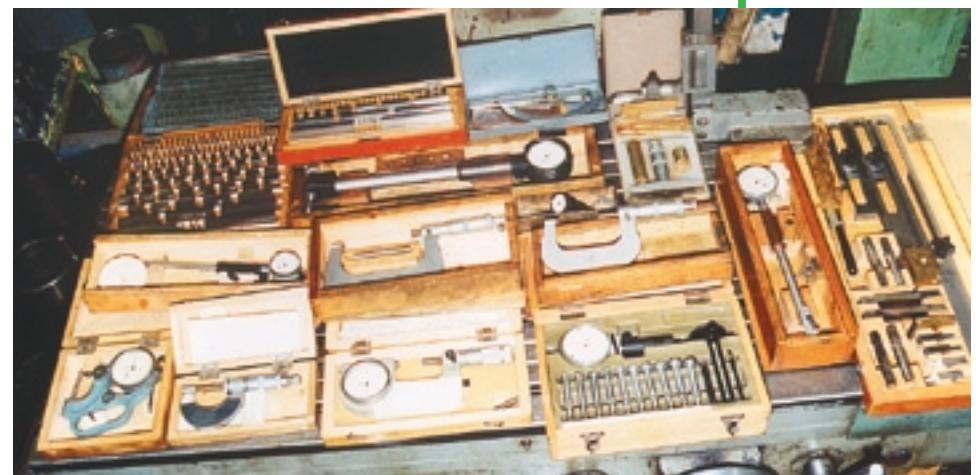
метры, как взаимное биение шеек валов и неплоскость привалочных поверхностей блока и головки блока. Обычно определить такие отклонения не составляет большого труда при наличии индикаторной стойки с призмами и лекальной линейки с набором щупов.
