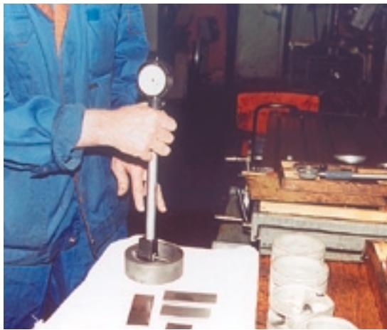
Чтобы точно измерить абсолютный размер отверстия, необходимо настраивать нутромер по специальному кольцу-калибрю. Для большинства моторных измерений такая точность не требуется.
