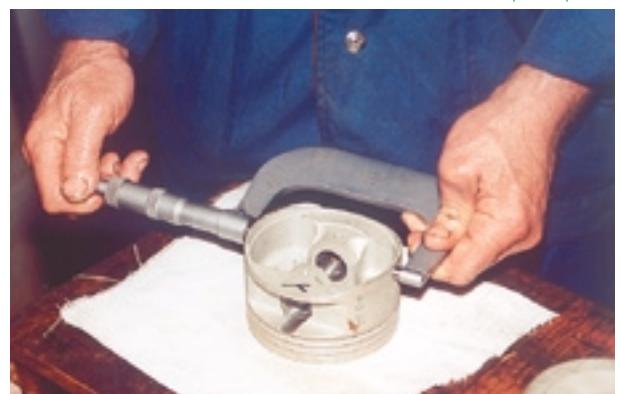
Регулярная поверка микрометра с помощью концевых мер длины обязательна, чтобы быть уверенным в результатах измерений абсолютного размера.
