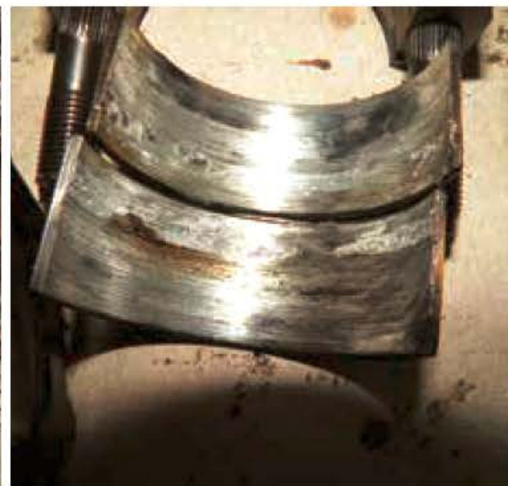
↑ Непродолжительная работа на масле с осадком (слева) закономерно приводит к закупориванию маслоприемника и выходу из строя подшипников (справа).
