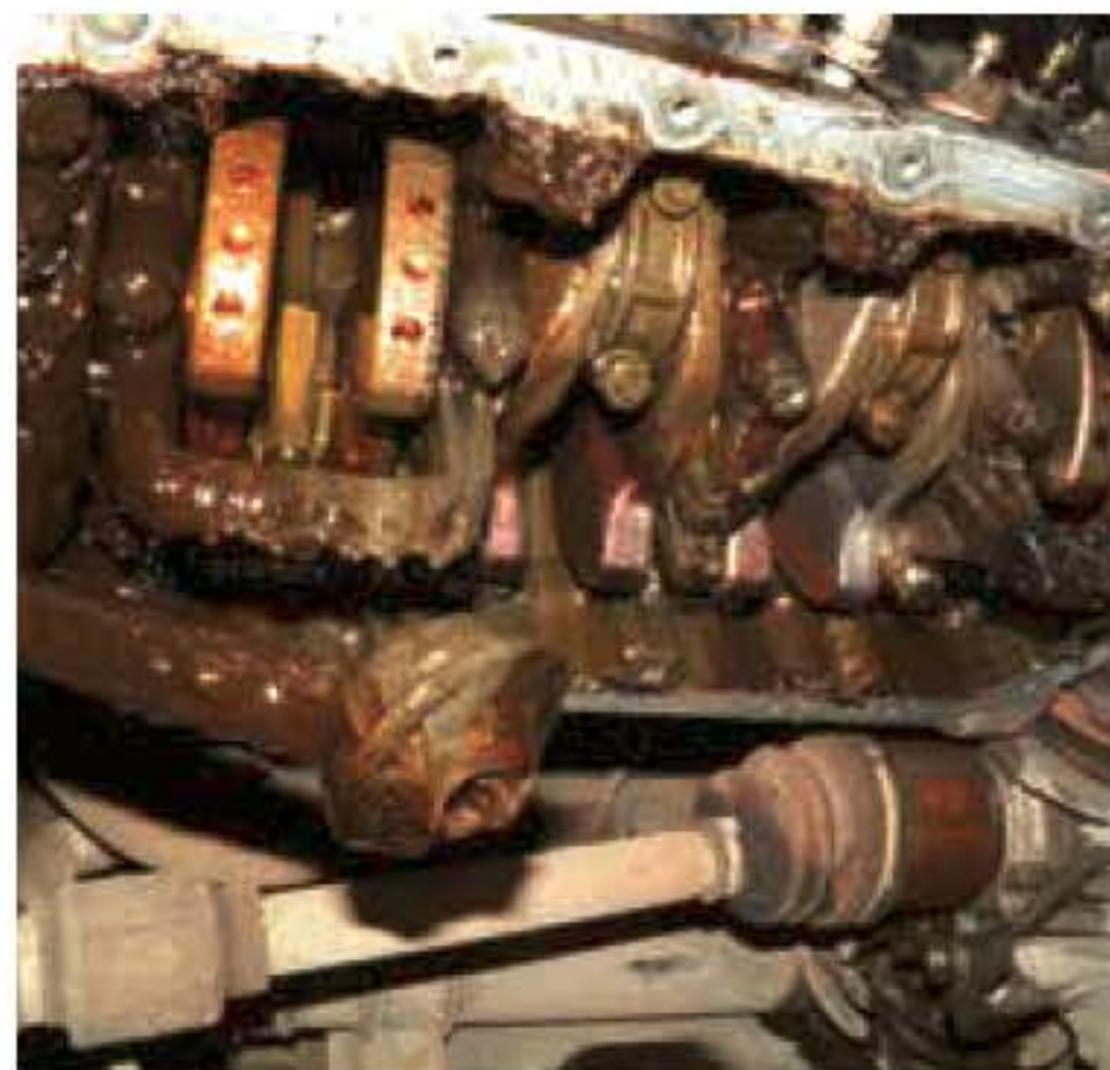
↑ Непродолжительная работа на масле с осадком (слева) закономерно приводит к закупориванию маслоприемника и выходу из строя подшипников (справа).
