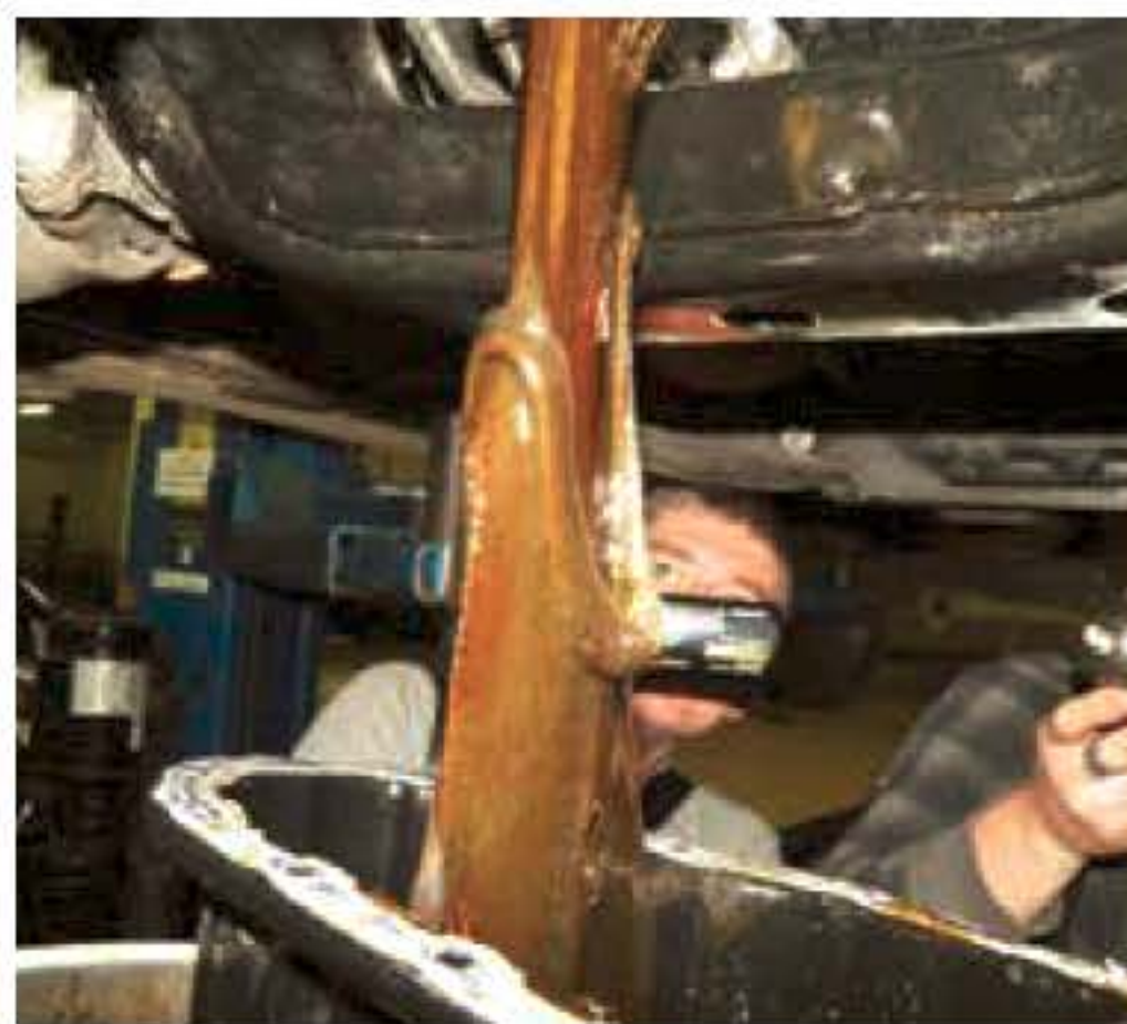
ⓘ Наиболее тяжелые случаи изменения свойств моторного масла происходят при воздействии топлива: образование осадка (слева) и преобразование масла в «резиноподобную» массу (справа).
