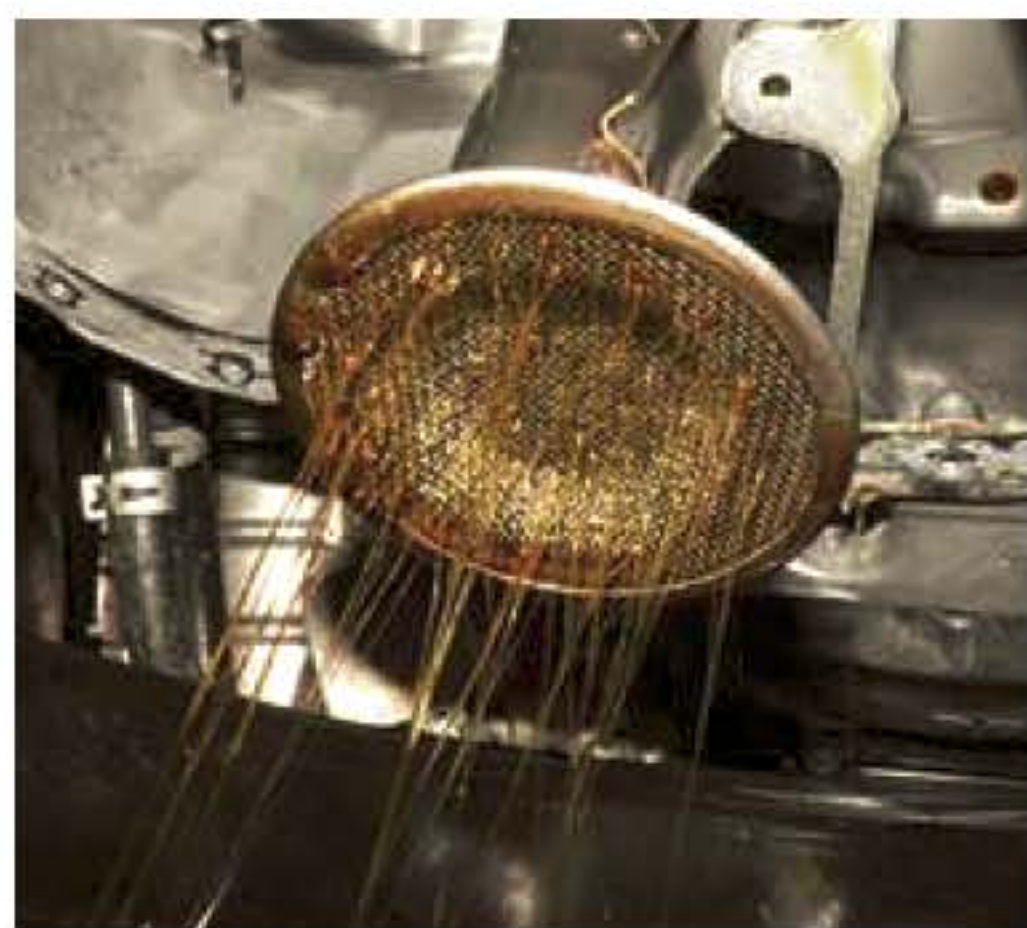
↑ «Обрезиненное» масло после пробега нового автомобиля 450 км (слева) и «резиновая подошва» из масла, обнаруженная при снятии поддона картера двигателя нового автомобиля после пробега менее 1000 км (справа).
