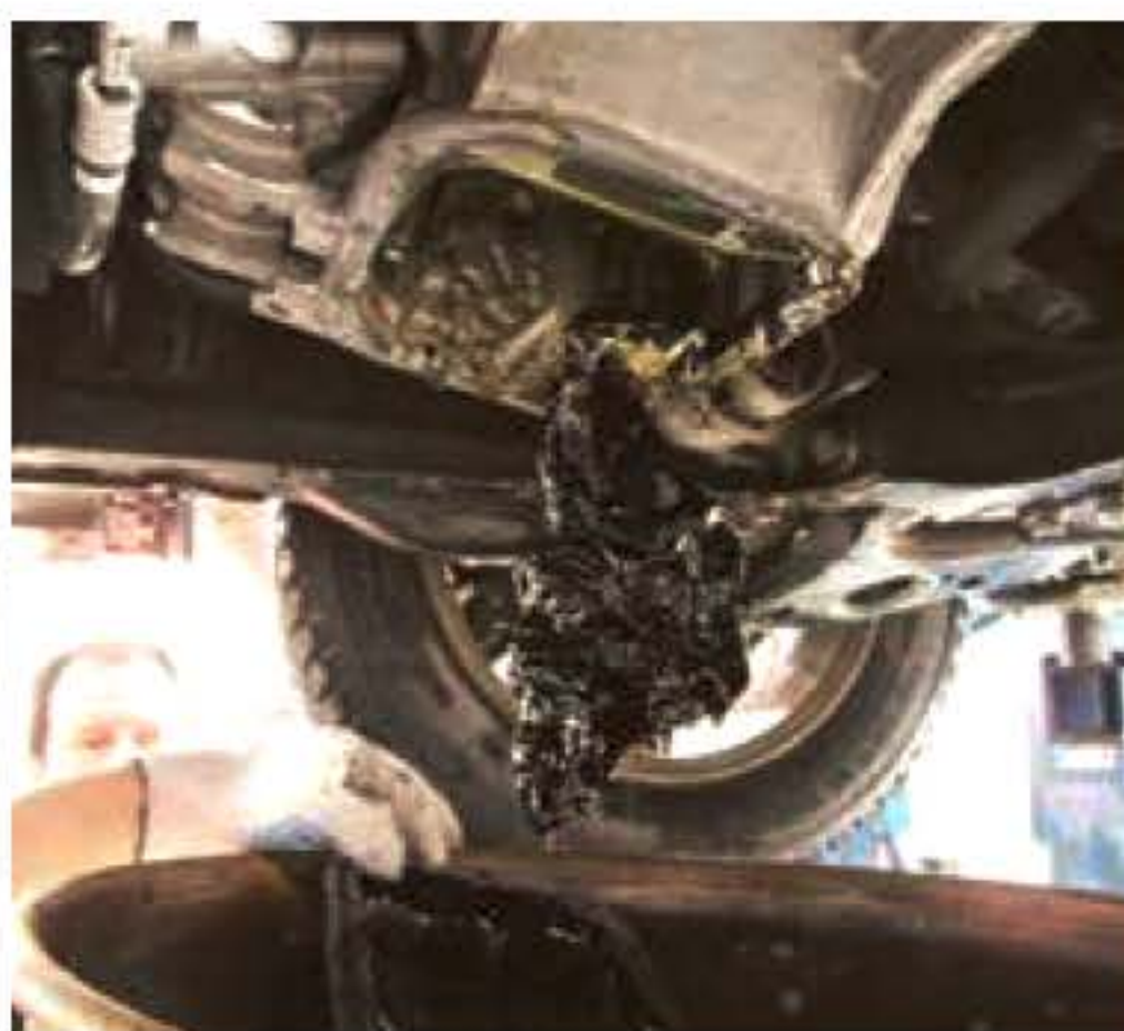
↑ «Обрезиненное» масло после пробега нового автомобиля 450 км (слева) и «резиновая подошва» из масла, обнаруженная при снятии поддона картера двигателя нового автомобиля после пробега менее 1000 км (справа).
