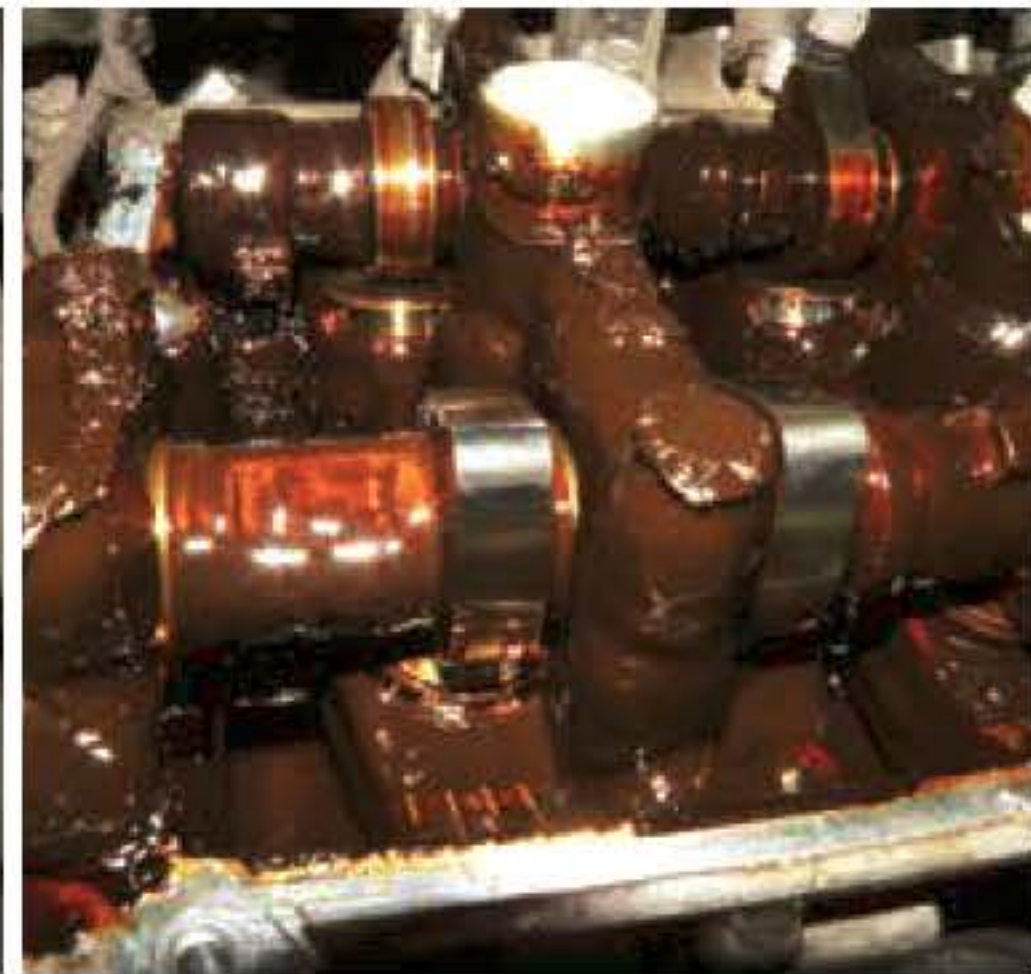
ⓘ Типичные случаи сравнительно «легкого» изменения свойств моторного масла в виде твердого нагара (слева) и мазеобразных отложений (справа) на стенках.
