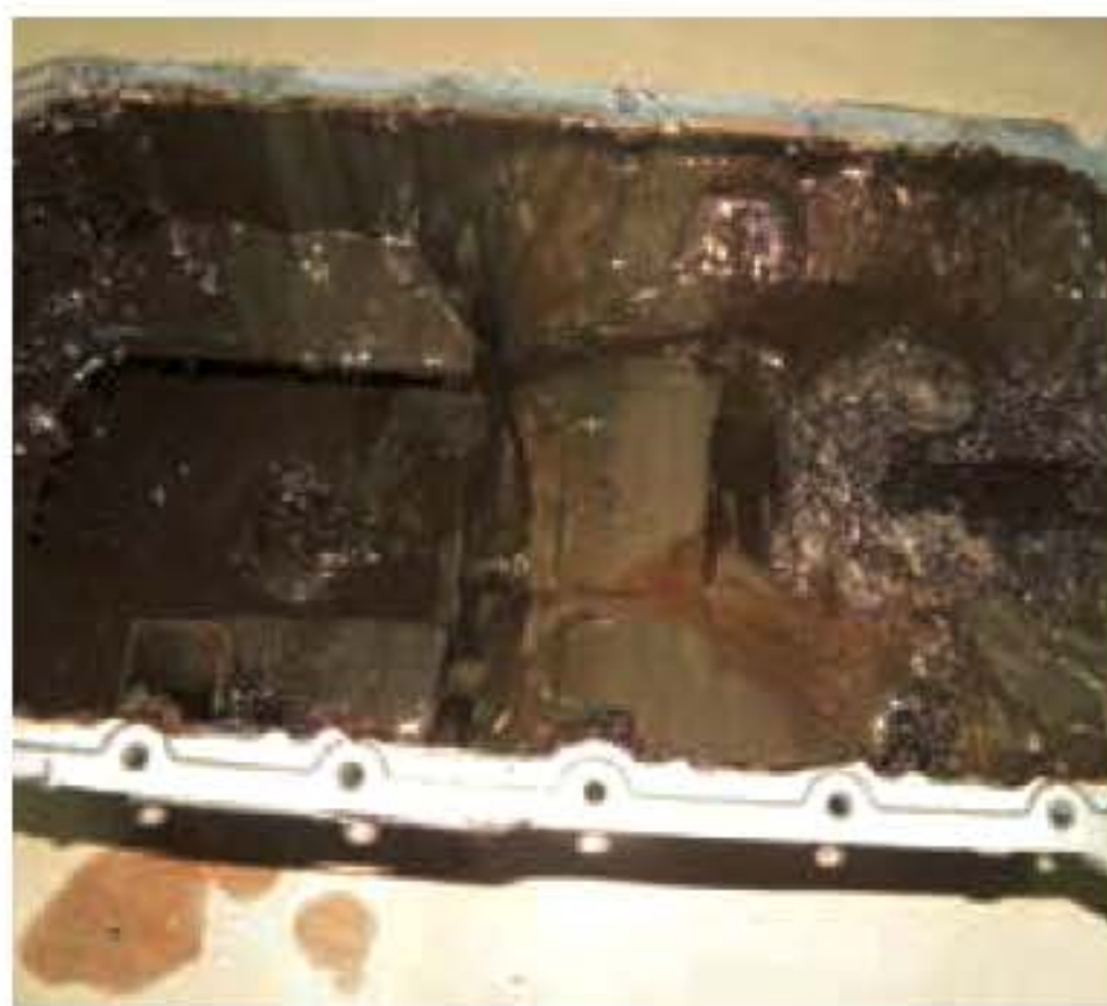
ⓘ Наиболее тяжелые случаи изменения свойств моторного масла происходят при воздействии топлива: образование осадка (слева) и преобразование масла в «резиноподобную» массу (справа).
