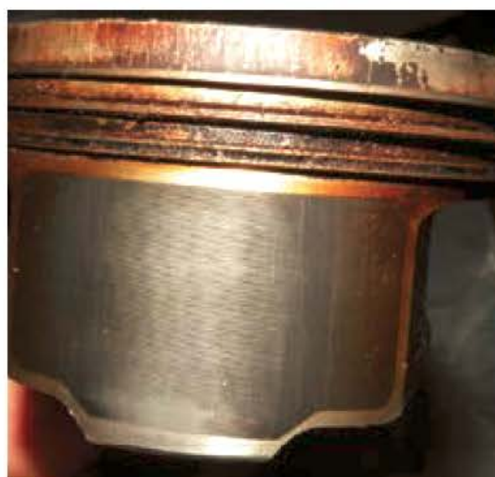
↑ Характер воздействия на масло, который условно можно отнести к локальному: от блокирования пазов в маслоъемных кольцах (слева) до полного блокирования всего уплотнительного пояса поршня (справа).
