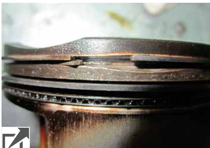
Когда пыль разъела канавку верхнего кольца на поршне, кольцо стало вибрировать и в итоге сломалось
