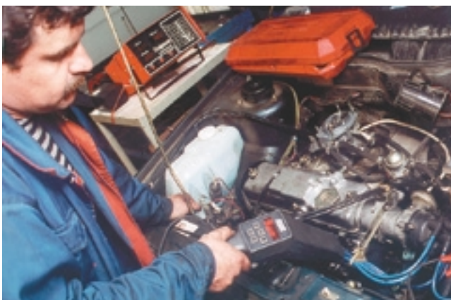
Настройка карбюратора и зажигания после установки нового распредвала занимает немало времени.
