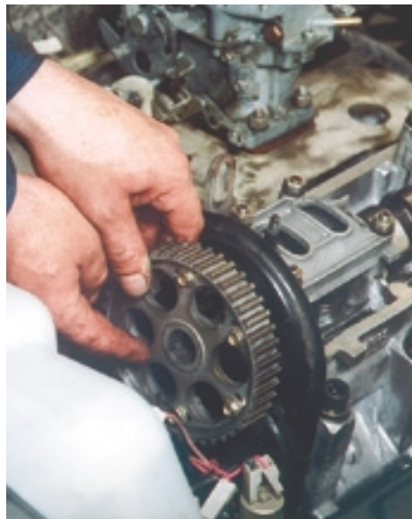
Правильно установить распределительный вал без специального «разрезного» зубчатого шкива невозможно.
