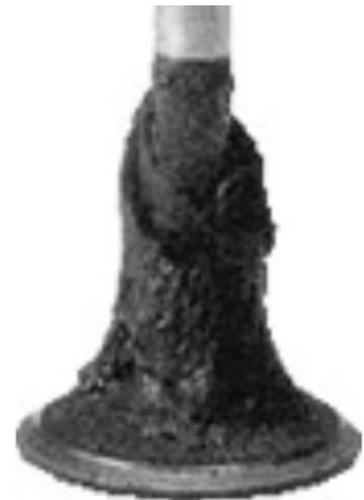
*Когда масло легко проникает через зазор между стержнем и направляющей втулкой, тарелка клапана быстро покрывается нагаром*
