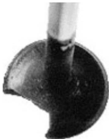
Скол на тарелке образуется из-за неплотной посадки в седле, ударных нагрузок или ненормального горения топлива
