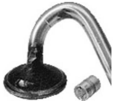
*Разрушение по пазу сухаря может случиться из-за неправильной разборки и сборки клапана, а также вследствие больших зазоров в приводе*
