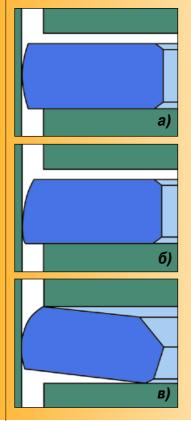
У кольца прямого профиля (а) несимметричная бочкообразная поверхность может быть получена специальной обработкой наружной поверхности кольца (б) или закручиванием кольца при сжатии за счет фаски (в)
