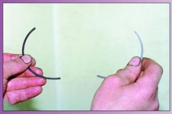
Кольцо из высокопрочного чугуна деформируется «в линию», из серого чугуна — сразу ломается
