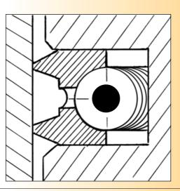
Наборное маслосъемное кольцо с двухфункциональным расширителем — основной вариант маслосъемного кольца на двигателях японских и американских автомобилей
