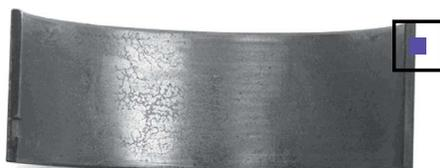
Усталостное разрушение покрытия триметаллического подшипника
