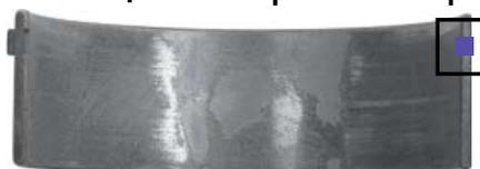
Кавитационная эрозия мягкого покрытия из свинцового сплава
