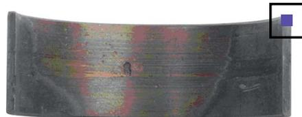
Усталостное разрушение бронзового промежуточного слоя триметаллического подшипника
