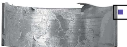
Усталостное разрушение алюминиевого слоя биметаллического подшипника
