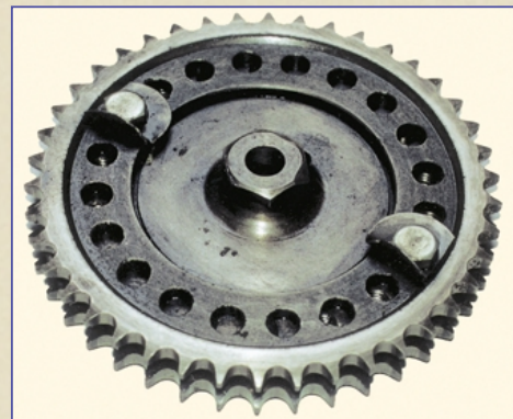
Такая звездочка позволяет точно установить фазы газораспределения.
