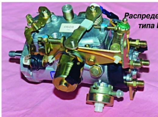
**Распределительный насос BOSCH с электронным управлением**
