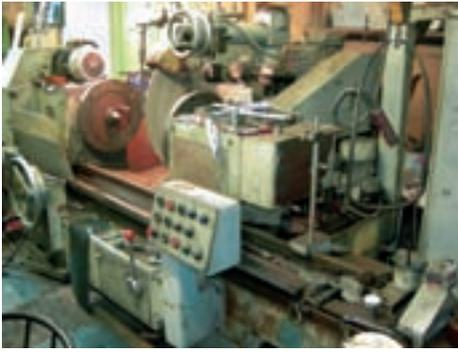
Старый шлифовальный станок украинского производства уже исчерпал все свои возможности по ремонту современных коленчатых валов — его точность явно недостаточна, а про удобство работы на нем вообще промолчим. Хотя по нынешним меркам не старый еще агрегат — 1992 года выпуска.
