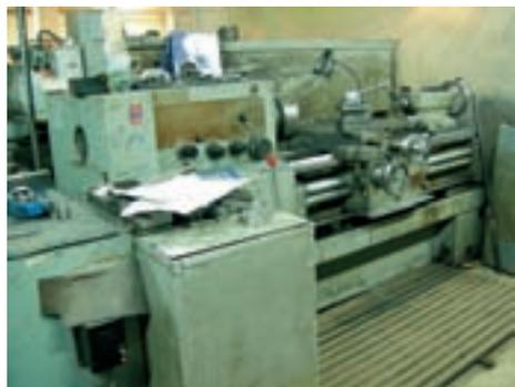
«Зато мы делаем ракеты», т.е. имеем массу старых универсальных токарных станков. Конечно, без них не выточить ремонтного седла или гильзы. Но в современном моторном ремонте такой станок может играть только вспомогательную роль. И стоять в уголке, где его никто не видит...
