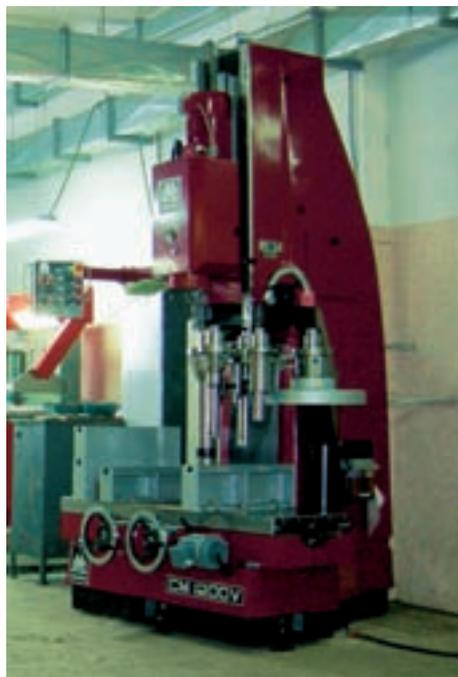
Современный расточной станок для блоков цилиндров — это не только плавные регулировки скоростей и подач, но и специальная система центрирования шпинделя и оснастка для любых блоков «на все случаи жизни». Думать ни о чем не требуется — производитель давно обо всем позаботился, да и станок за оператора сам все «чувствует» — достаточно только выполнять операции согласно прилагаемым инструкциям.
