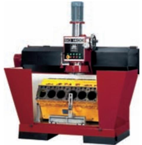
Специализированного станка для обработки плоскостей головок и блоков цилиндров наша промышленность так и не освоила, в то время как сделать качественную обработку плоскости на универсальном отечественном аналоге весьма проблематично. Хотя бы вследствие полного отсутствия необходимой оснастки...
