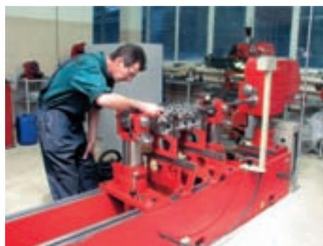
**Еще один специализированный станок — горизонтально-расточной для расточки постелей подшипников. Завидная универсальность, позволяющая расточить любые соосные отверстия в диапазоне 22–200 мм при любом обзримом габарите головки или блока цилиндров. Устаревшие отечественные аналоги давно не выпускаются, сравнивать не с чем...**
