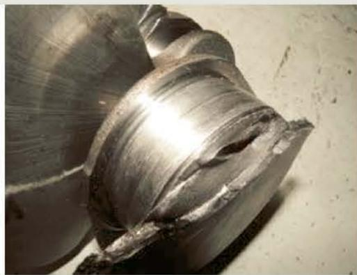
↑ ШЕЙКИ, ПРИМЫКАЮЩИЕ К МЕСТУ ПОЛОМКИ, ПОЛУЧИЛИ СЕРЬЕЗНЫЕ ПОВРЕЖДЕНИЯ ИЗ-ЗА НАРУШЕНИЯ СМАЗКИ....
