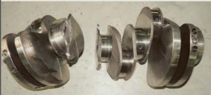
↑ КОЛЕНВАЛ ПОСЛЕ ДЕМОНТАЖА ИЗ ДВИГАТЕЛЯ ПРОСТО "РАСПАЛСЯ" НА 2 ЧАСТИ.
