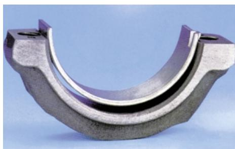
Размер вкладыша подшипника, измеренный по поверхности разъема, должен быть больше диаметра постели. Благодаря этому вкладыш при монтаже плотно прилегает к постели.
