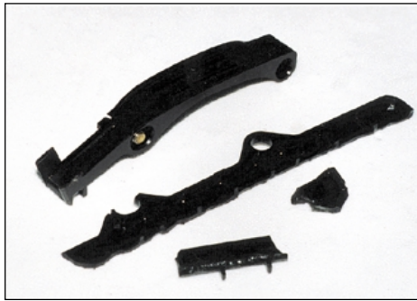
Неисправный натяжитель привел к разрушению направляющих цепи.
