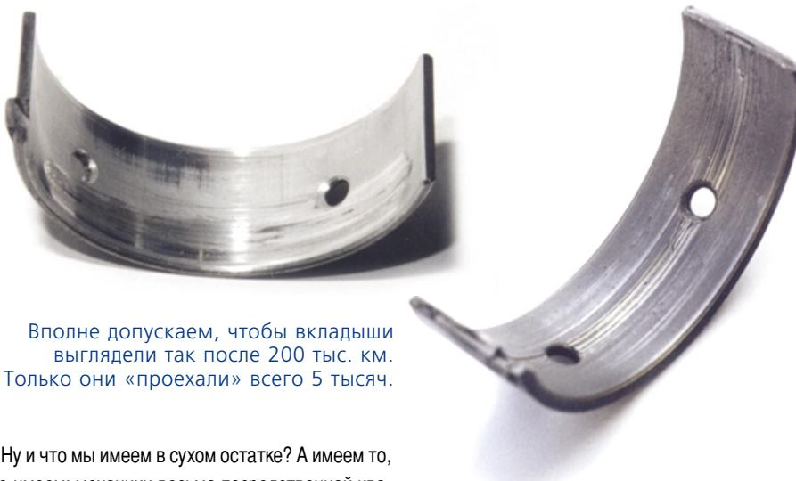
Вполне допускаем, чтобы вкладыши выглядели так после 200 тыс. км. Только они «проехали» всего 5 тысяч.
