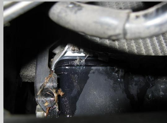
Повреждения прокладок ГБЦ вследствие вытекания охлаждающей жидкости
