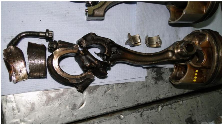
Рис.7. Пример сочетания главного признака масляного голодания (усталостное разрушение нижней головки шатуна) с комплексом подтверждающих признаков (перегрев нижней головки, частичное разрушение поршня и полное разрушение шатунного подшипника).
