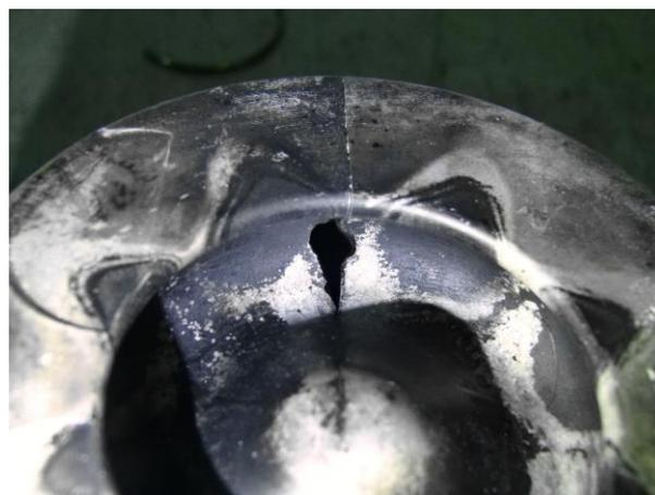
Рис. 6. Трещина в днище дизельного поршня, проходящая вдоль оси пальца - один из признаков нештатного повышения давления наддува в результате "тюнинга" двигателя
