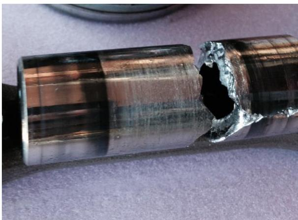
Рис. 8. Пример усталостного разрушения поршневого пальца
