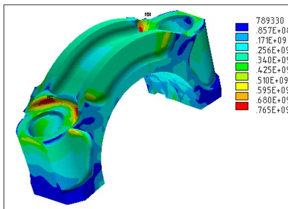
Рис. 15. Критическое сечение крышки шатуна, обнаруженное при моделировании
