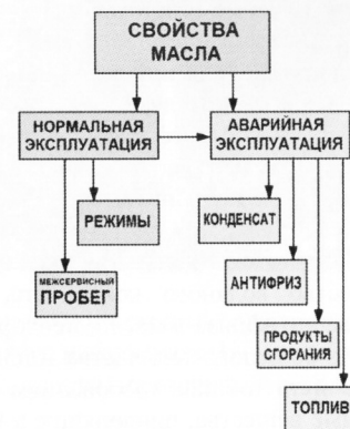
Рисунок 1 – Свойства моторного масла оказывают решающее влияние на работоспособность и ресурс ДВС: при воздействии на масло различных факторов его свойства могут измениться, в результате чего эксплуатация из нормальной превратится в аварийную
