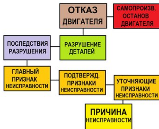
Рисунок 3. Прямая логическая схема (направление анализа – снизу-вверх), в общем виде описывающая данные по отдельно выделенной неисправности (отказу)
