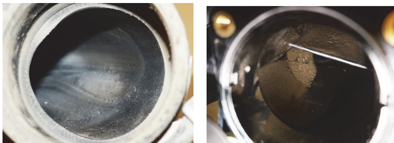
Рис.2. Загрязнение мелкой пылью воздуховода (слева) и впускного коллектора (справа) при работе двигателя с некачественным воздушным фильтром
