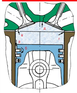
заведомо меньше подачи воздуха. Вследствие этого компрессия падает не столь значительно (приблизительно до 0,8-0,9 МПа). Поэтому способ замеров с открытой заслонкой лучше подходит для определения более «грубых» дефектов двигателя, таких, как поломки и прогары поршней, поломки
