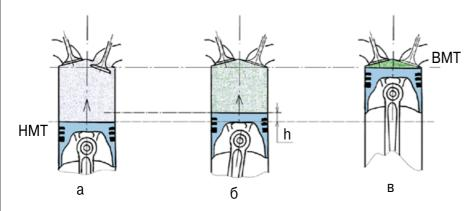
При движении поршня из нижней мертвой точки (a) давление начинает повышаться только после закрытия впускного клапана (б) и достигает максимума в верхней мертвой точке (в): h — перемещение поршня, при котором давление в цилиндре не повышается
