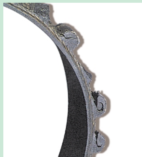
Подрез зубьев у основания часто возникает из-за слабого натяжения ремня или изношенного шкива.
