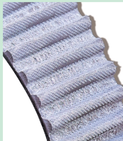
Износ впадин зубьев из-за чрезмерного натяжения или износа шкивов.
