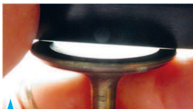
5.164. Ползучесть материала впускного клапана под действием высокой температуры, вызванной отказом системы регулирования подъема, стала причиной характерной «тюльпанообразной» деформации головки клапана
