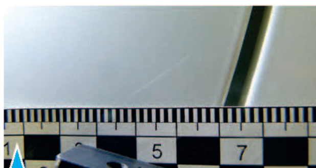
22. Дверь задняя левая – царапина на лакокрасочном покрытии
