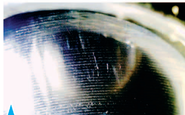
7.11. На рабочей сферической поверхности шарнира рулевой тяги сохранился технологический микрорельеф
