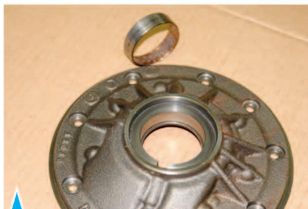
6.61. Разрушенный подшипник скольжения насоса
