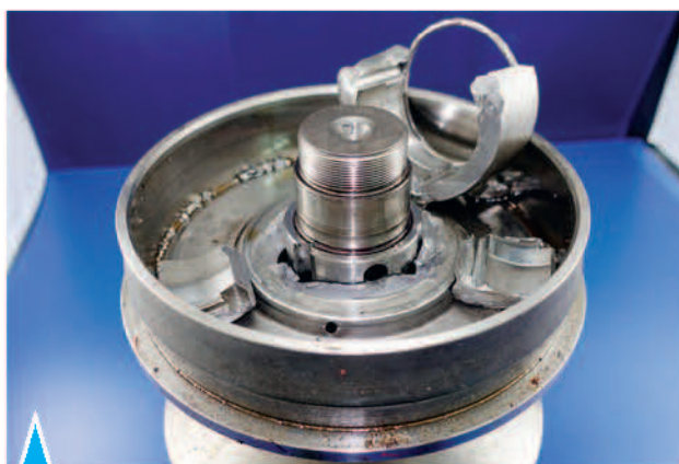
6.315. Разрушение конуса вариатора
