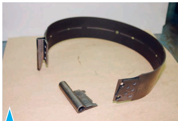
6.442. Отрыв замковой части тонкой тормозной ленты
