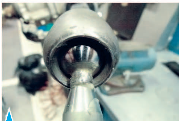
7.10. Нормальное состояние шарового шарнира рулевой тяги
