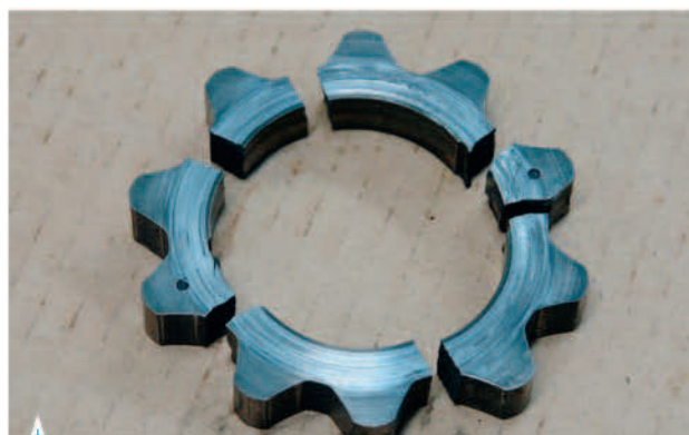
6.63. Разрушение ведущей шестерни насоса
