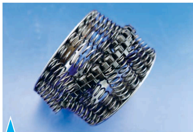
6.440. Разрушение отжимных пружин сцепления
