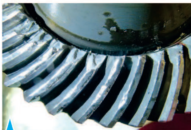
6.261. Разрушение зубьев из-за ударных нагрузок
