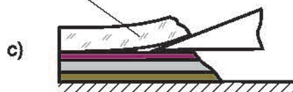
9.10.9. Оценка адгезии условно неразрушающим методом с помощью препаровальной иглы со специальной заточкой: а) высокая адгезия; б) пониженная адгезия покрытия с поверхностью детали; с) пониженная межслойная адгезия покрытия
