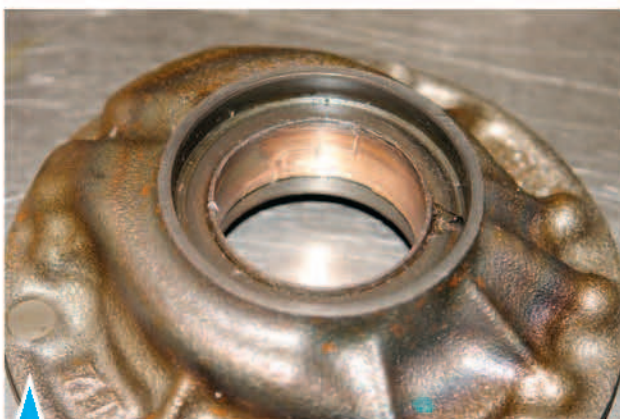
6.60. Изношенный подшипник скольжения насоса
