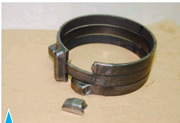
6.441. Разрушение замковой части тройной тормозной ленты
