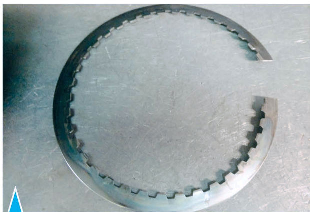
6.439. Разрушение пружины плавности пакета фрикционных дисков
