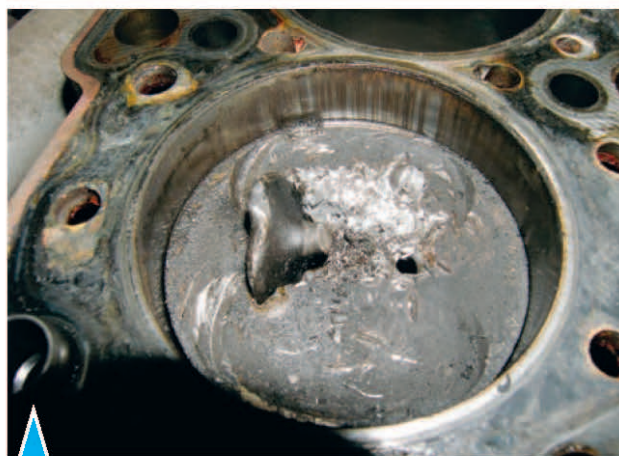
2.31. Разрушение стержня клапана с отделением головки
