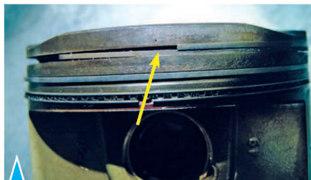
2.37. Разрушение компрессионного кольца
