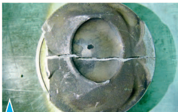
2.35. Разрушение поршня в результате ударов о головку цилиндров
