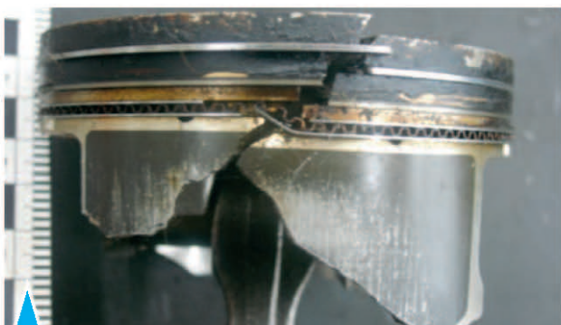
2.36. Разрушение поршня и поршневых колец
