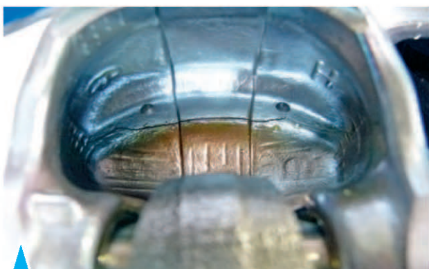
2.34. Разрушение поршня по канавке масляе-ного кольца (вид с внутренней стороны поршня)
