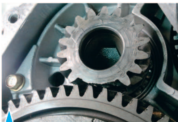
6.259. Разрушение зубьев при изгибе (вид 1)
