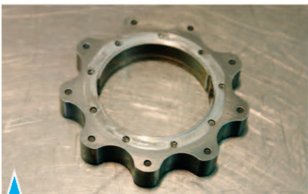
6.62. Разрушение приводных элементов (усов) ведущей шестерни насоса
