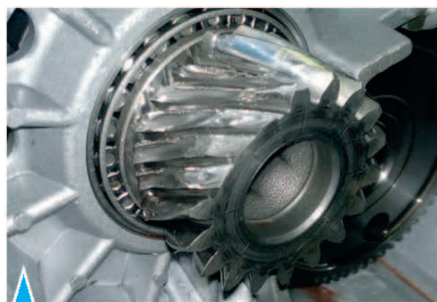
6.260. Разрушение зубьев при изгибе (вид 2)
