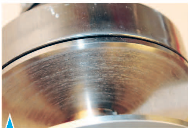
6.317. Износ и задиры на конусной поверхности шкивов вариатора 2
