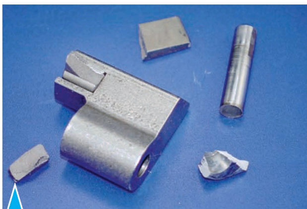
6.443. Разрушение привода тормозной ленты
