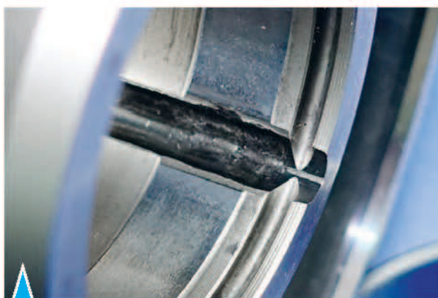
6.319. Износ направляющей подвижной части конуса шкива вариатора
