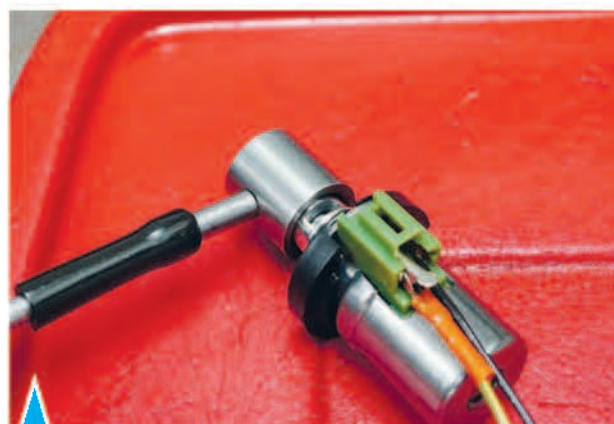
6.188. Проверка работоспособности электрогидравлических клапанов
