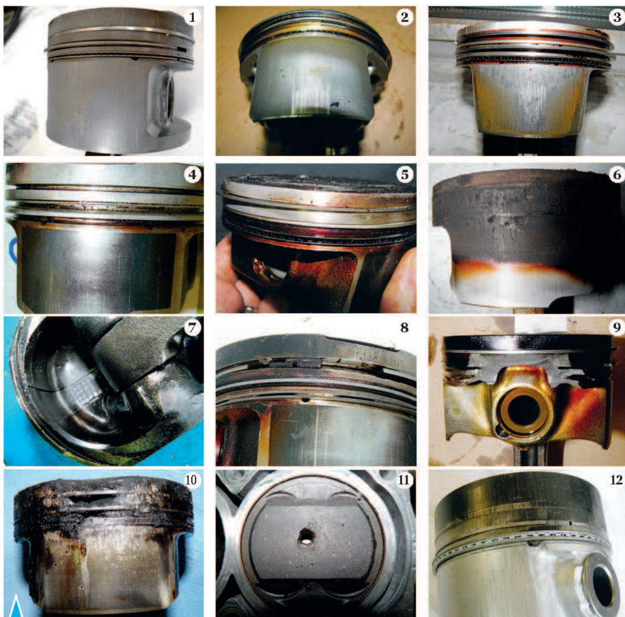
5.194. Основные виды повреждений поршней: 1 – абразивный износ; 2 – повреждение частицами; 3 – задиры; 4 – большой зазор в цилиндре (износ юбки); 5 – неправильная работа из-за деформации шатуна; 6 – низкое качество масла; 7 – перегрев поршня или некачественное масло; 8 – размывание канавки при колебании сломанного поршневого кольца; 9 – детонация; 10 – перегрев поршня после поломки колец и/или перемычек; 11 – калильное зажигание; 12 – нарушение масляного охлаждения
